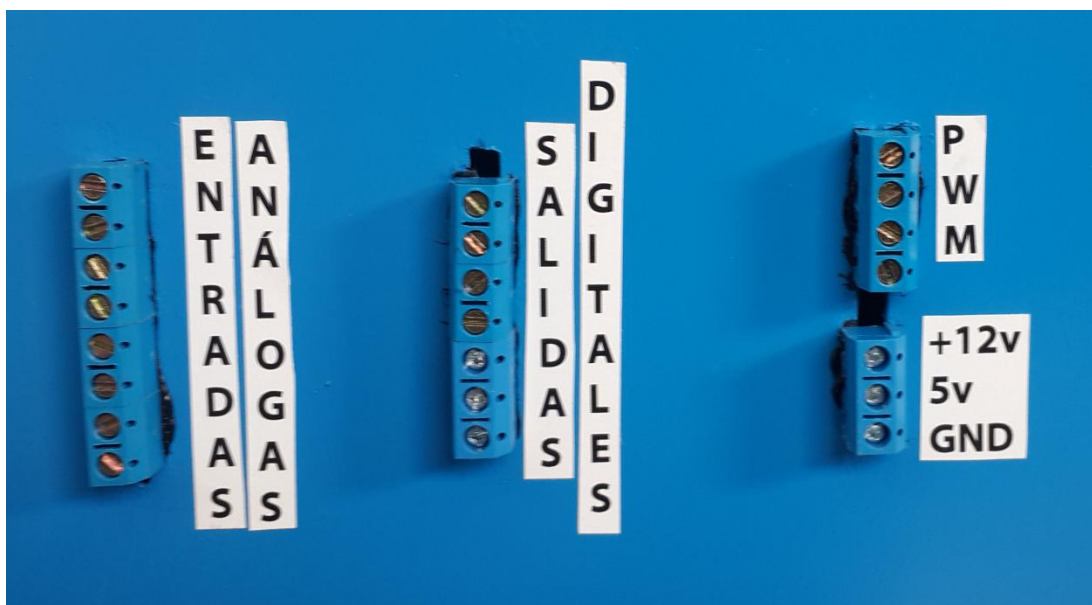
Figura 20. Implementación de las entradas y salidas adicionales.
