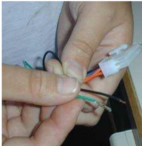
Figura 21. Habilitación de la fuente ATX.
