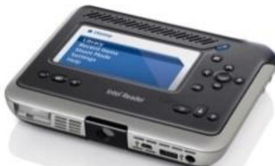
**Figura 10 Escáner de mano (Intel Reader)**
