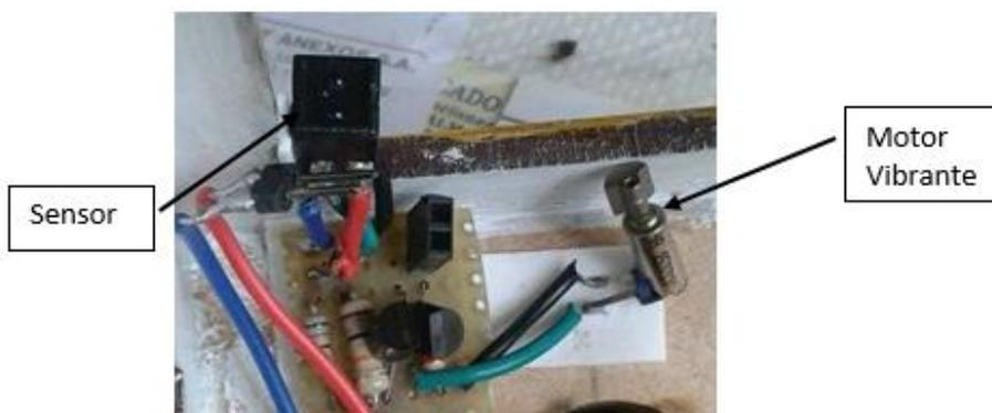
**Figura 34 Implementación del sensor y el motor vibrante.**
