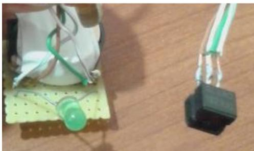
**Figura 33 Circuito de prueba del sensor CNY70**
