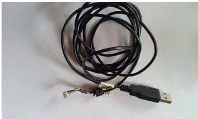
**Figura 29 Dispositivo plug-play obtenido de una webcam**
