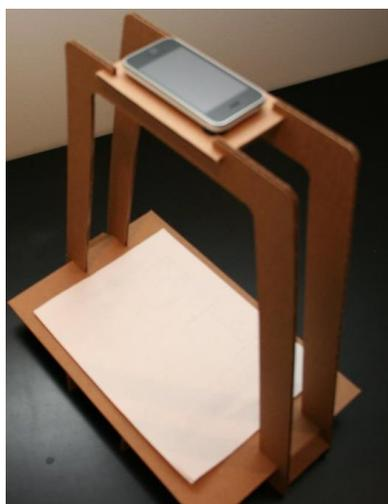
**Figura 12 Cámara Scanner**
