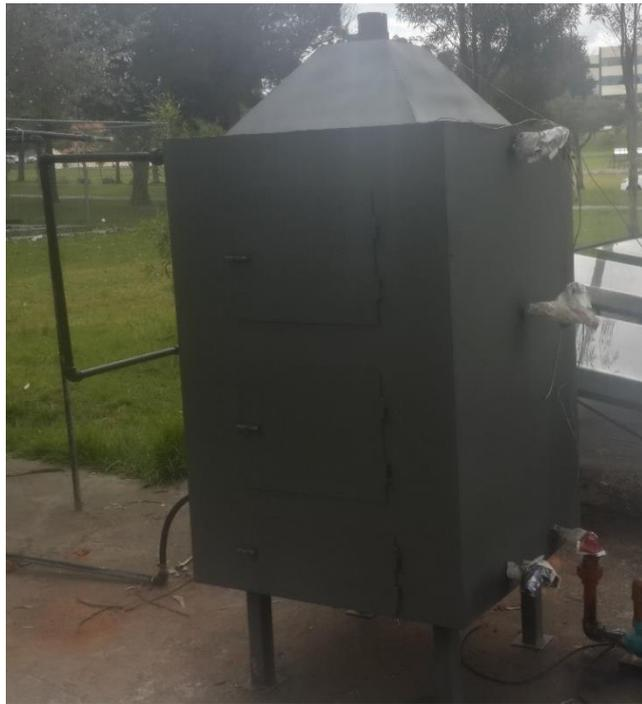
**Figura 64. Recubrimiento con pintura anticorrosiva**
