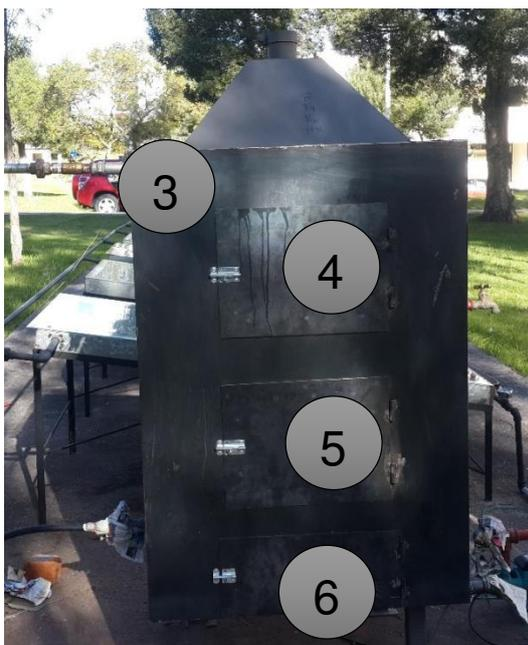
**Figura 63. Ensamblaje del recubrimiento frontal y puertas**
