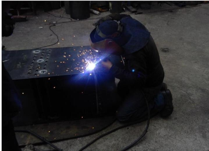
**Figura 52. Soldadura de los tubos del intercambiador de calor.**
