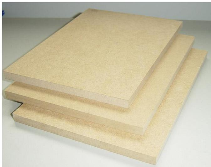
**Figura 25. Aislamiento de fibra de madera.**
