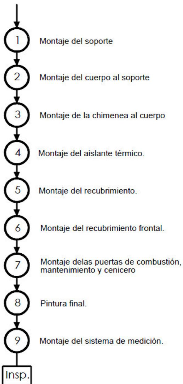
Figura 60. Cursograma del ensamblaje del sistema biomasa.
