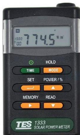
**Figura 73. Medidor portátil de radiación solar**
