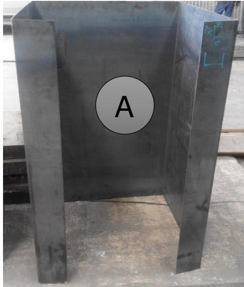
**Figura 47. Doblado de la placa rectangular A**
