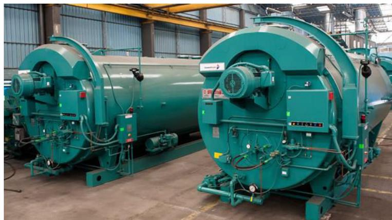
**Figura 3. Calderas industriales para generación de vapor.**
