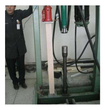
**Figura 72** Ensayo Columna tipo I No. 11 – 9.6x12x122 [cm] de madera laminar contrachapada de 12mm
