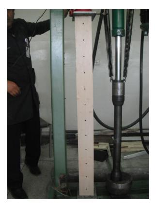
**Figura 80** Falla Columna tipo I Ca No. 17 – 12x15x142cm con rigidizadores de madera laminar contrachapada de 15mm (Pandeo en dirección de la menor Inercia)
