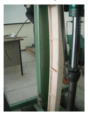
**Figura 71** Falla Columna tipo I Cl No.7- 6x15x122 [cm] con rigidizadores de madera laminar contrachapada de 15mm (Pandeo en sentido de la menor Inercia)
