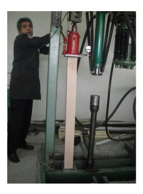
**Figura 64** Ensayo Columna tipo I Ca No. 10-9.6x9.6x122 [cm] de madera laminar contrachapada de 12mm
