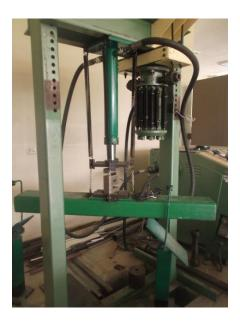
Figura 11 Prensa Hidráulica y aparatos de soporte
