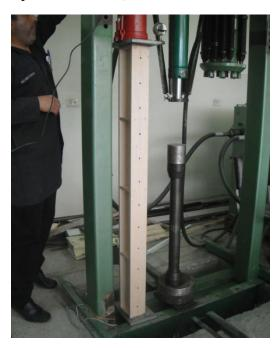
**Figura 83** Ensayo Columna tipo I Ca No.9.6x12x142 [cm] con rigidizadores de madera laminar contrachapada de 12mm
