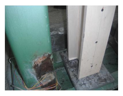
**Figura 77** Falla Columna tipo I No23- 9,6x12x142 [cm] de madera laminar contrachapada de 12mm (Aplastamiento en la base)
