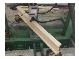
**Figura 23** Ensayo Viga tipo I No.3 6x15x1.5 (cm)
