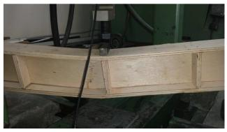
**Figura 36** Falla Viga I No. 6-12x15x122 cm con rigidizadores laterales
