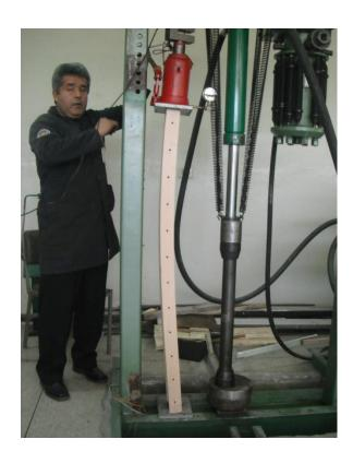
**Figura 82** Falla Columna tipo I Ca No.6- 6x15x142cm con rigidizadores de madera laminar contrachapada de 15mm (Pandeo en sentido de la menor Inercia)
