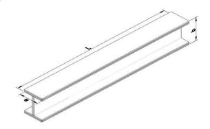
Figura 16 Viga laminada contrachapada tipo I (Dimensiones)
