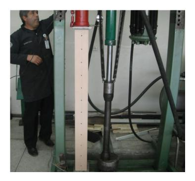
**Figura 74** Ensayo Columna tipo I Ca No.14 – 12x15x142 [cm] de madera laminar contrachapada de 15mm
