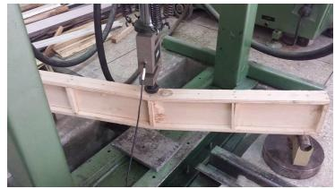
Figura 38 Falla Viga I No.9-6x15x122cm con rigidizadores laterales
