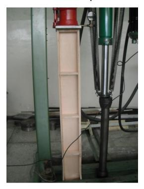
**Figura 69** Falla Columna tipo I No.3 -12x15x122 [cm] con rigidizadores de madera laminar contrachapada de 15mm (Aplastamiento)
