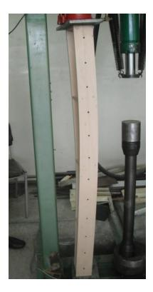
**Figura 84** Falla Columna tipo I Ca No.9.6x12x142 [cm] con rigidizadores de madera laminar contrachapada de 12mm (Pandeo en el sentido de la menor Inercia)
