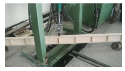
Figura 41 Ensayo Viga tipo I No.13- 6x15x244cm con rigidizadores laterales
