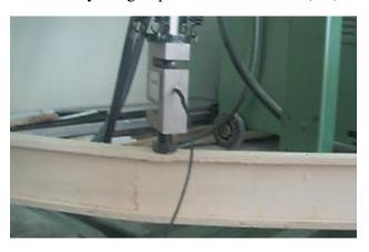
Figura 24 Falla Viga tipo I No.3 6x15x1.5 (cm)
