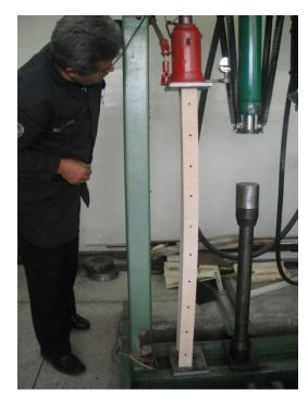
**Figura 63** Falla columna tipo I Ca No.3-6x15x122 [cm] de madera laminar contrachapada de 15mm (Pandeo en sentido de la menor Inercia)
