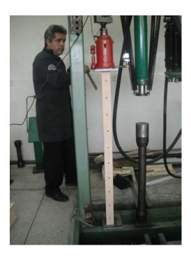
**Figura 62** Ensayo Columna tipo I Ca No.6-6x15x122 [cm] de madera laminar contrachapada de 15mm
