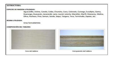
**Figura 5** Estructura del tablero contrachapado corriente de 15mm de espesor (http://www.endesabotrosa.com/images/pdfs/fichas-tecnicas-tableros.pdf)
