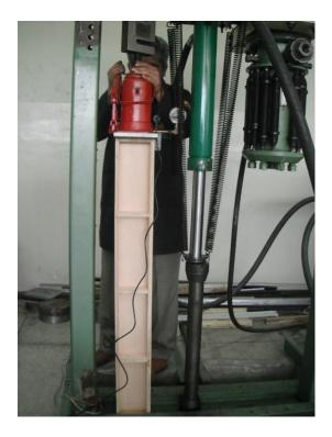
**Figura 68** Ensayo Columna tipo I No.3- 12x15x122 [cm] con rigidizadores de madera laminar contrachapada de 15mm
