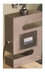
Figura 12Celda de carga
