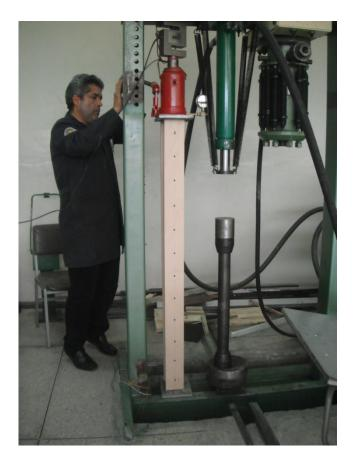
**Figura 76** Ensayo Columna tipo I No.23- 9.6x12x142 [cm] de madera laminar contrachapada de 12mm
