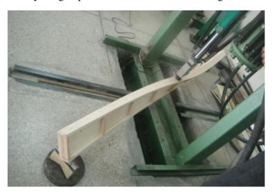
Figura 42 Falla Viga tipo INo.13-6x15x244cm con rigidizadores laterales
