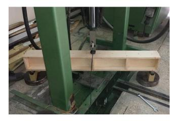
Figura 35 Ensayo Viga I No.6 -12x15x122 cm con rigidizadores laterales
