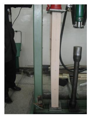
**Figura 73** Falla Columna tipo I Cl No. 11 – 9.6x12x122 [cm] con rigidizadores de madera laminar contrachapada de 12mm (Pandeo y torsión)
