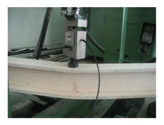
Figura 22 Falla Viga Tipo I No.1 12x15x1.5 (cm)
