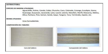
**Figura 48** Estructura del tablero contrachapado corriente de 15mm de espesor (http://www.endesabotrosa.com/images/pdfs/fichas-tecnicas-tableros.pdf)
