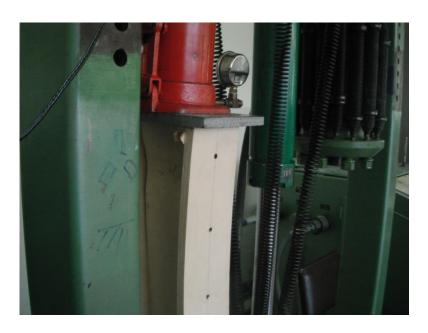
**Figura 75** Ensayo Columna tipo I Ca No.14 – 12x15x142 [cm] de madera laminar contrachapada de 15mm (Aplastamiento, pandeo)
