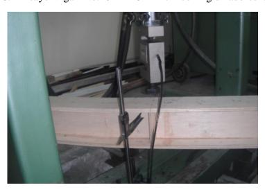
**Figura 40** Falla Viga I No. 10-12x15x244cm con rigidizadores laterales
