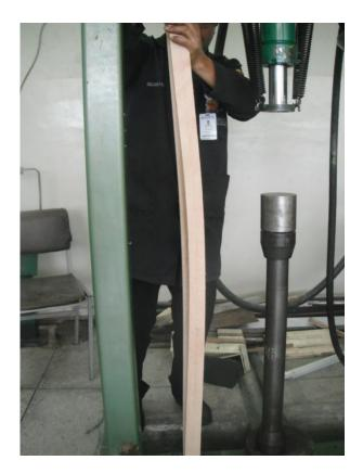
**Figura 78** Falla Columna tipo I Cl No. 26 – 4.8x6x142 [cm] de madera laminar contrachapada de 6mm (Pandeo en el sentido de la menor Inercia)
