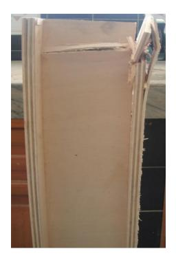
**Figura 61**Falla de la Columna Tipo I Cl No. 1-12x15x122 [cm] de madera laminar contrachapada de 15mm (Aplastamiento y rotura del ala y alma en la base)
