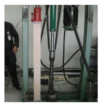
**Figura 79** Ensayo Columna tipo I Ca No. 17 – 12x15x142 [cm] con rigidizadores de madera laminar contrachapada de 15mm
