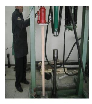
**Figura 66** Ensayo Columna tipo I Cl No.13- 4.8x6x122 [cm] de madera laminar contrachapada de 6mm
