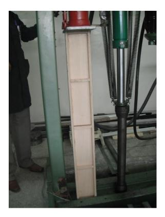
**Figura 70** Ensayo Columna tipo I Cl No.7- 6x15x122 [cm] con rigidizadores de madera laminar contrachapada de 15mm
