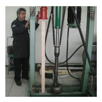
**Figura 81** Ensayo Columna tipo I Ca No.6 -6x15x142 [cm] con rigidizadores de madera laminar contrachapada de 15mm
