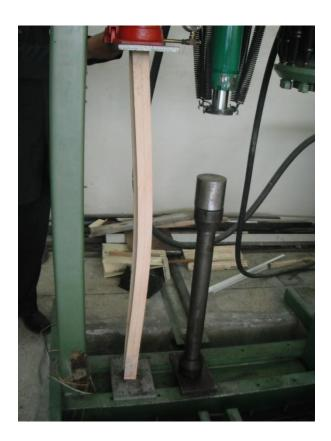
**Figura 67** Falla Columna tipo I Cl No.13- 4.8x6x122 [ cm] de madera laminar contrachapada de 6mm (Pandeo en dirección de la menor Inercia)
