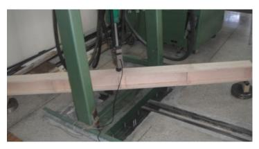
Figura 39 Ensayo Viga I No.10-12x15x244cm con rigidizadores laterales
