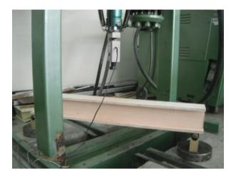
Figura 21 Ensayo Viga Tipo I No.1 12x15x1.5 (cm)
