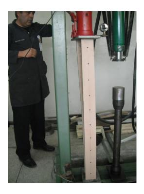
**Figura 65** Falla Columna tipo I Ca No. 10 – 9.6x9.6x122 [cm] de madera laminar contrachapada de 12mm (Pandeo y torsión)
