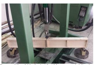
**Figura 37** Ensayo Viga I No.9- 6x15x122 cm con rigidizadores laterales
