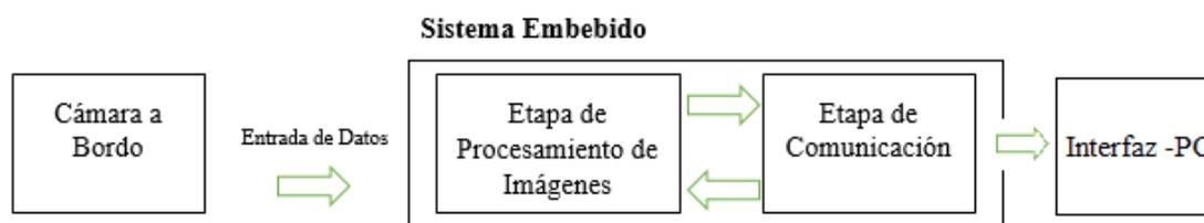
**Figura 28 Estructura sistema embebido**
