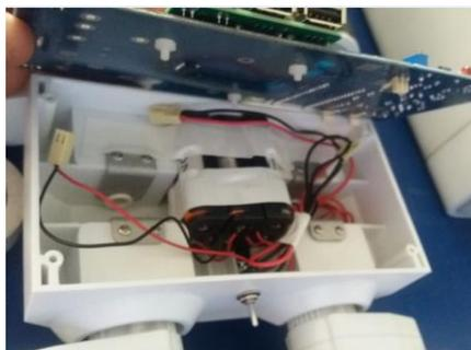
**Figura 61 Conexión de motores DC**
