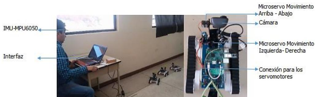
**Figura 49 Conexión para los microservos**
