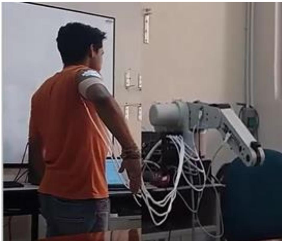
**Figura 52** Posición del codo del brazo humano y brazo robótico a  $-45^\circ$
