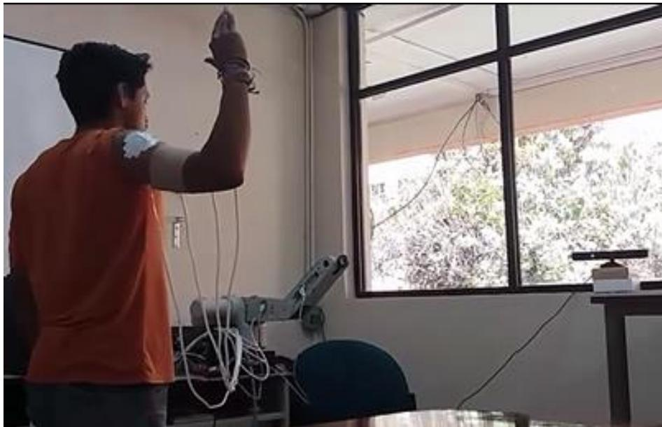
**Figura 51** Posición del codo del brazo humano y brazo robótico a  $60^\circ$
