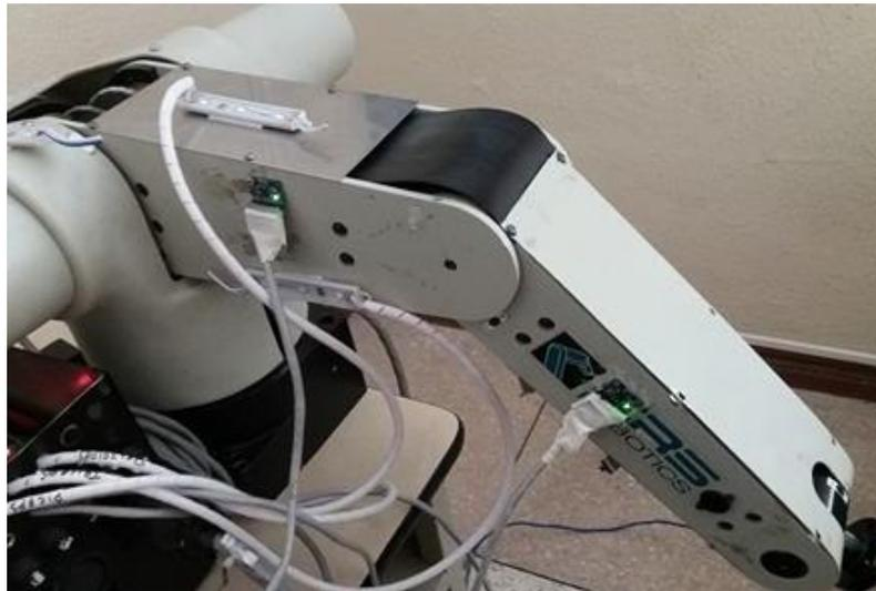
**Figura 37 Ubicación de los MPU6050 en el brazo robótico**
