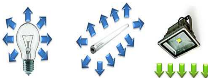
Figura 30 Flujo luminoso de diferentes luminarias. Fuente: (SC, 2015)
