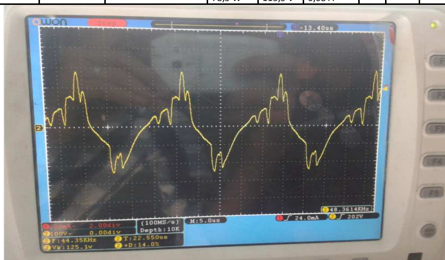
Figura 38 Forma de la onda de tensión a la salida del balastro Silvanya.
