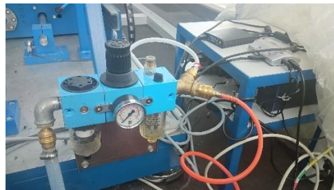
Figura 38. Sistema de sujeción neumático para el huso.
