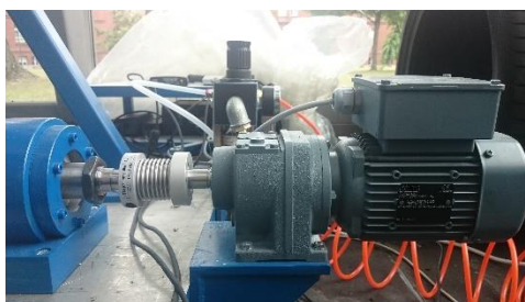
Figura 36. Motor eléctrico de accionamiento del uso.
