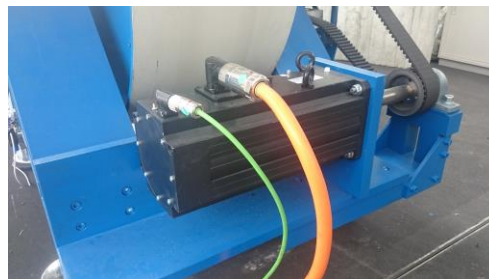
Figura 40. Motor eléctrico de accionamiento del tambor.
