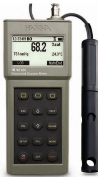
Figura 129: Medidor de Oxígeno Disuelto HANNA HI 98186
