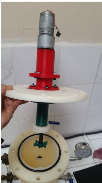
Figura 83: Ensamble del sistema de corte con la tapa del reactor modelo
