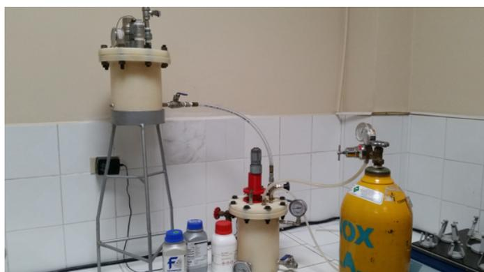
Figura 84: Disposición del reactor, equipos e instrumentos para la fabricación de nanopartículas
