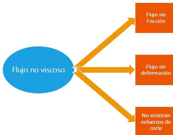
Figura 9: Diagrama sobre las suposiciones en flujo no viscoso
