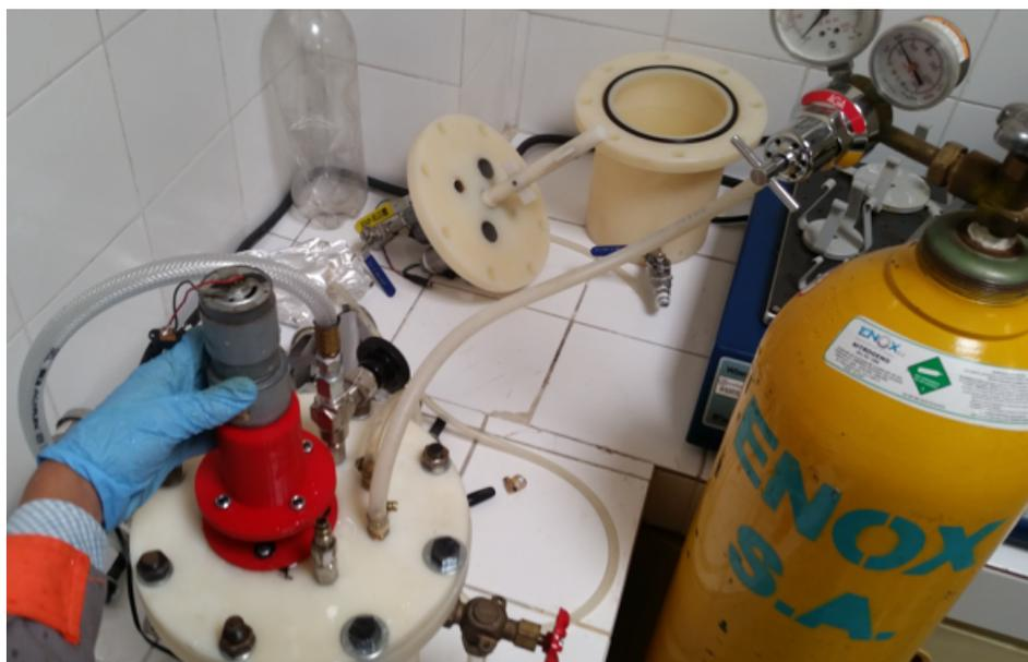
Figura 90: Nitrogenación del Reactor
