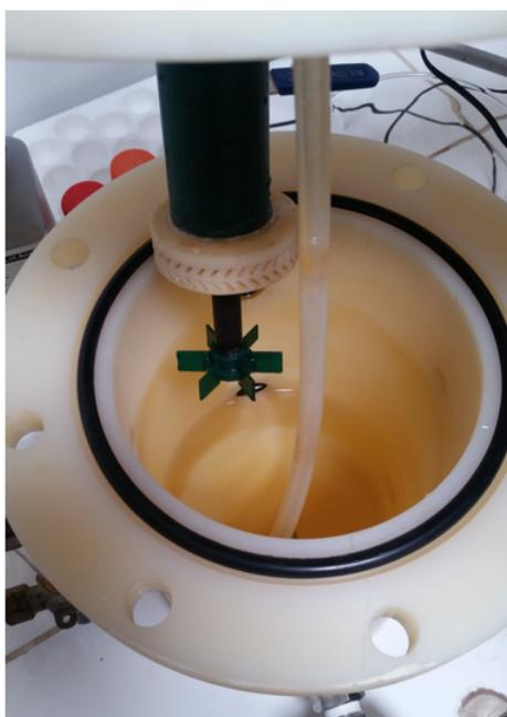
Figura 86: Mezclado de la Solución de  $FeCl_3$
