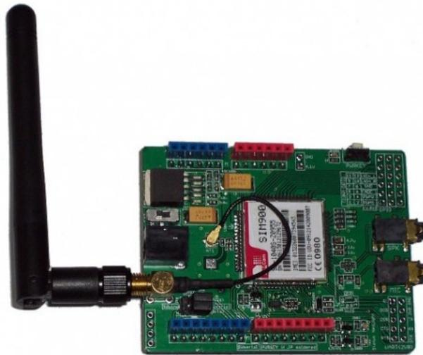
Figura 8: Módulo transmisor GSM/GPRS.
