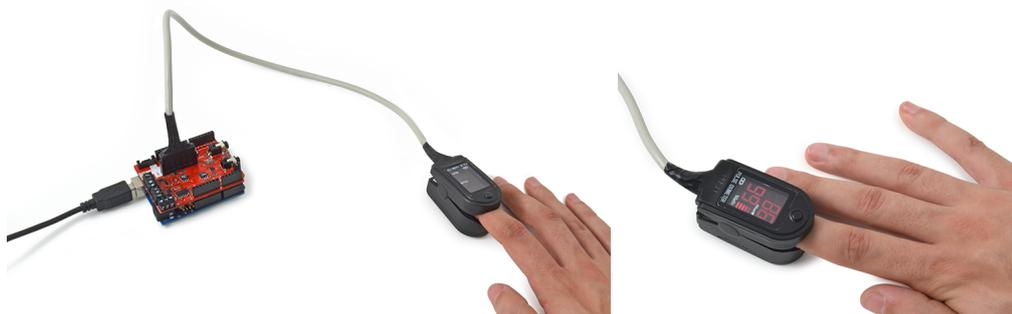
Figura 15: Conexión del sensor de oximetría de pulso.
