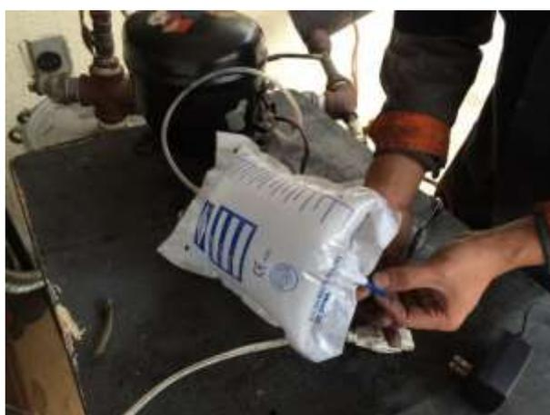
**Figura 33** Funda para muestra del gas de síntesis
