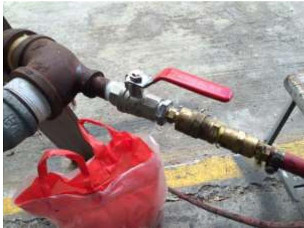
**Figura 26** Conexión del aire comprimido al Venturi
