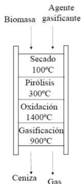
**Figura 14** Esquema de gasificador downdraft
