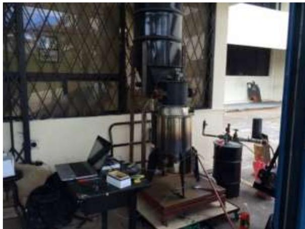
**Figura 31** Gasificador en operación
