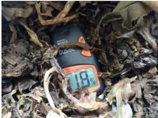
**Figura 20** Medición de la humedad de la biomasa (lechuguín)
