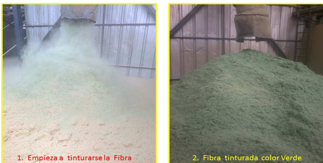
Figura 6 Proceso de tintura de la fibra de madera, color verde
