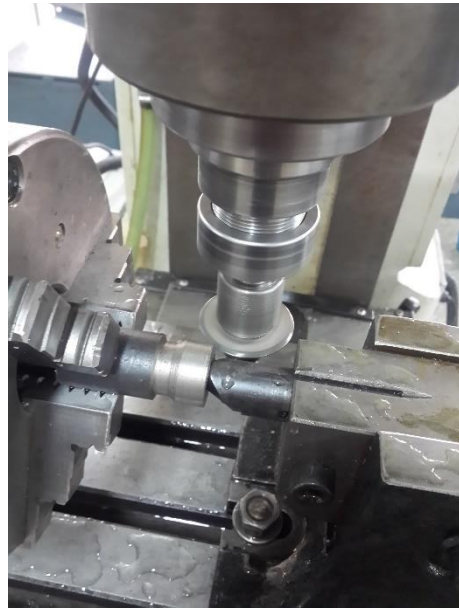
Figura 80. Tallado de los dientes del engranaje.
