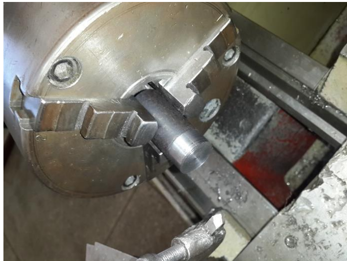
Figura 79. Cilindrado del material para engranajes.
