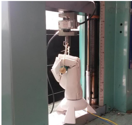
Figura 89. Montaje de la prótesis en la máquina de ensayos.
