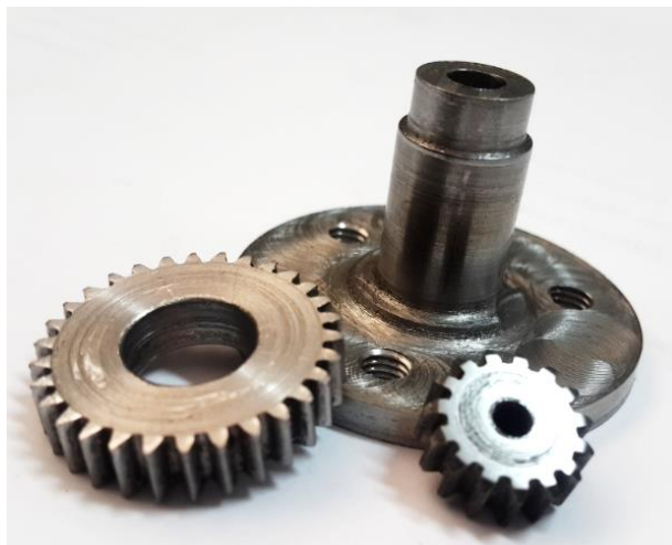
Figura 82. Elementos de acero en la transmisión de potencia.
