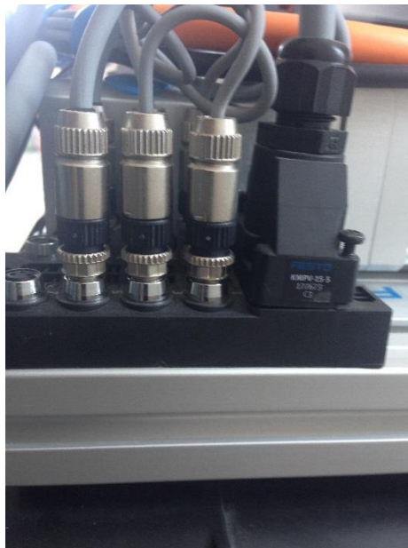
Figura 177. Acumulador de señales en base ranurada
