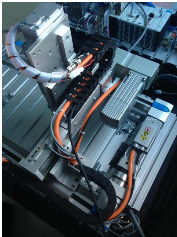
Figura 176. Cadenas porta cables Ejes XY y Ejes YZ
