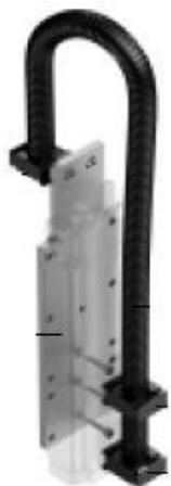
Figura 86. Placa para fijación de ejes YZ
