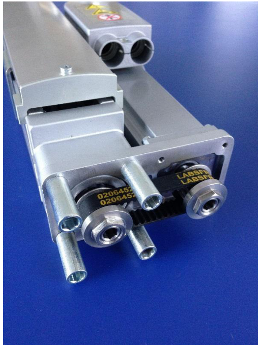
Figura 171. Transmisión por banda dentada eje Z
