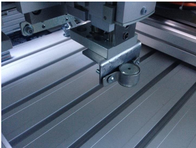
Figura 175. Montaje de la garra magnética
