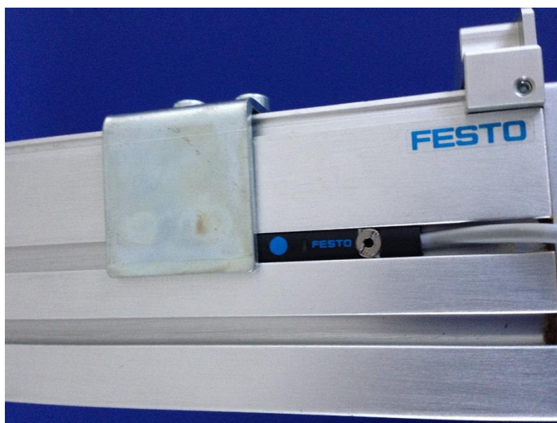
Figura 174. Instalación de sensor final de carrera y leva de conmutación
