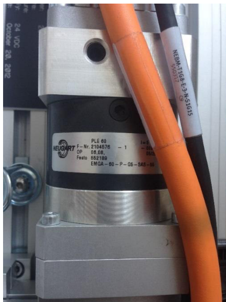
Figura 167. Engranaje planetario reductor 5:1
