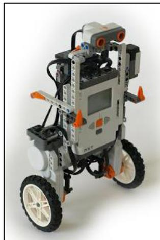
Figura 41. Péndulo invertido de base móvil con ruedas
