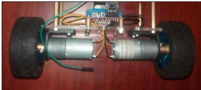
Figura 73. Colocación de motores y sus respectivos acoples y ruedas
