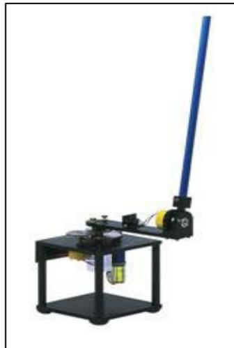
Figura 40. Péndulo invertido de base con movimiento giratorio
