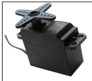
**Figura 44. Servomotor**
