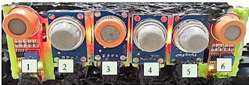
**Figura 35** Arreglo de sensores químicos MQ, donde (1) MQ-3 derecha, (2) MQ-2, (3) MQ-3 centro, (4) MQ-4, (5) MQ-135 y (6) MQ-3 izquierda
