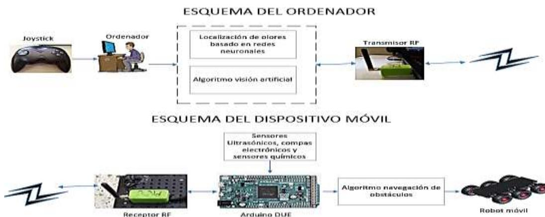
**Figura 31** Esquema control de la plataforma móvil
