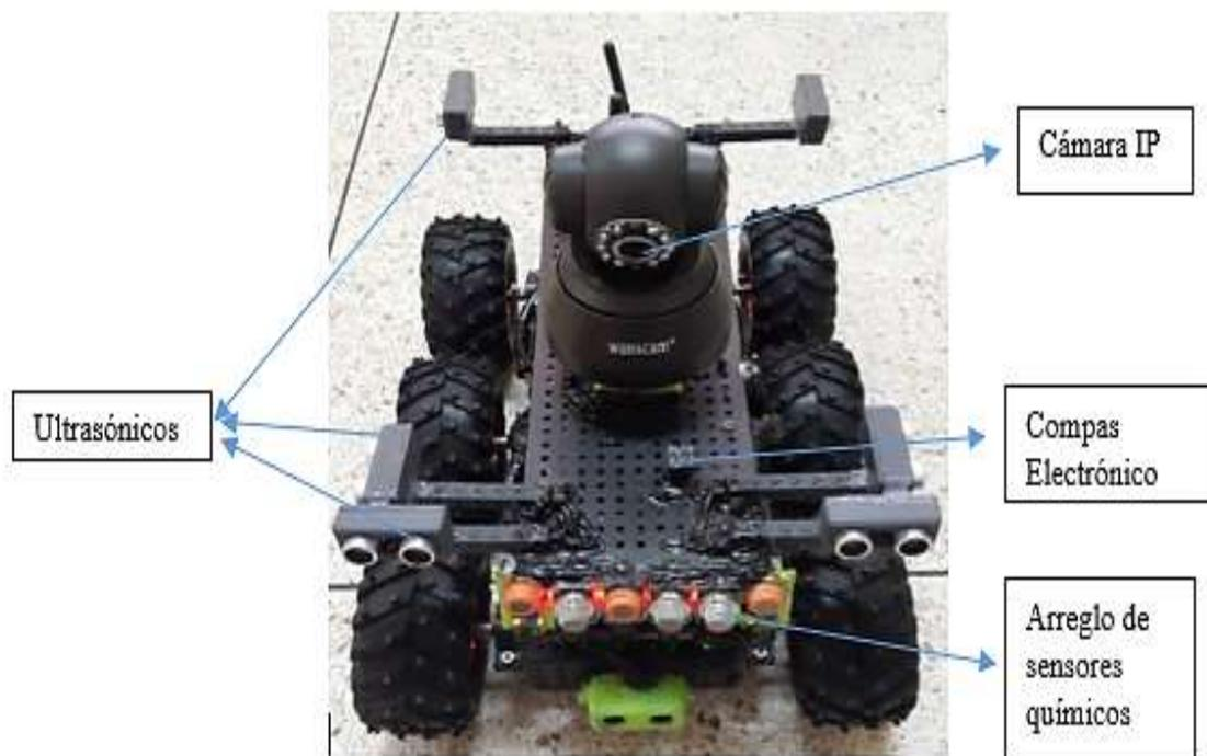
Figura 47 Dispositivo móvil conectado exterior
