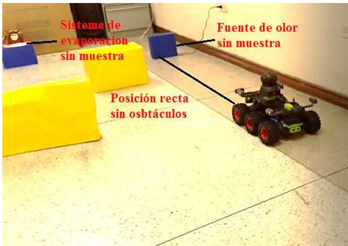
**Figura 91** Ambiente controlado, donde se observa a las fuentes de olor sin muestra y sin obstáculos en la trayectoria recta del dispositivo móvil
