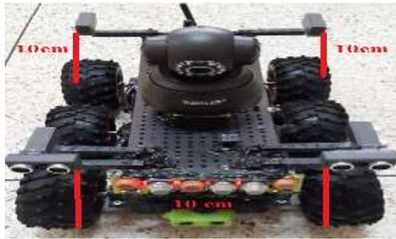
**Figura 32** Altura de sensores ultrasónicos laterales
