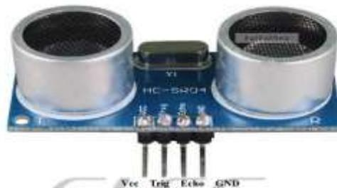
**Figura 33** Sensor Ultrasónico HR-SC04
