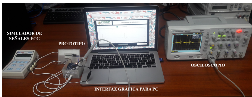
Figura 112 Escenario de pruebas para medir la calidad de señal ECG.
