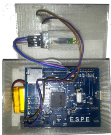
Figura 47 Tarjeta electrónica montada en la caja contenedor.
