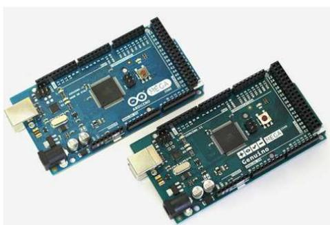
**Figura 43. Arduino Mega 2560**
