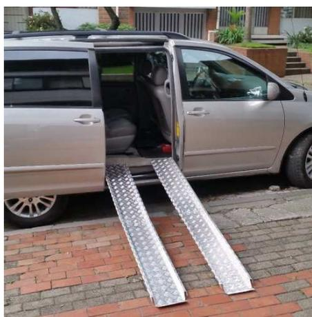
**Figura 11. Plataforma tipo rampa ingreso de silla de ruedas**
