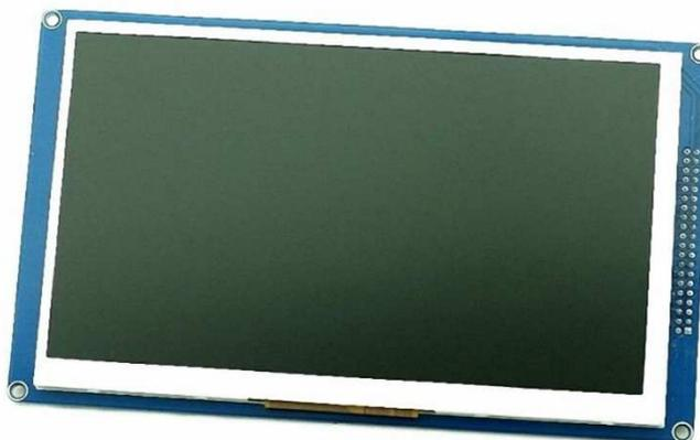
**Figura 49. Pantalla TFT, 4.3 pulgadas**
