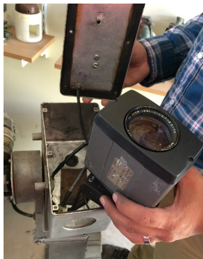
Figura 25. Cámara original del robot ubicada en la torreta
