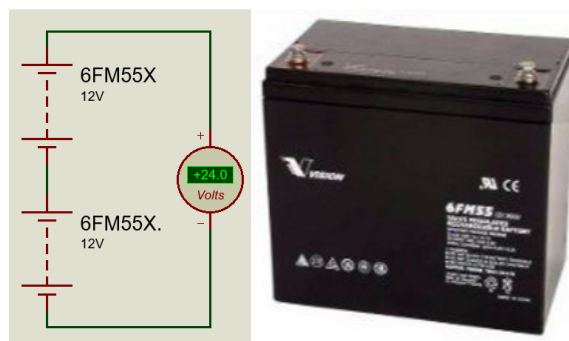
Figura 33. Batería AGM 12VDC y 55Ah
