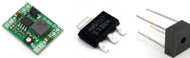
Figura 85. a) Conversor DC-DC mini buck. b) Regulador de voltaje AMS1117. c) Puente de Diodos.
