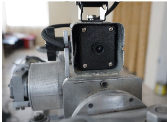
Figura 100. Acople de la cámara del gripper ensamblado en el brazo robótico
