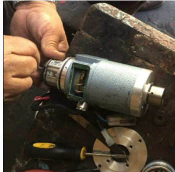
Figura 103. Mantenimiento preventivo de motor de codo
