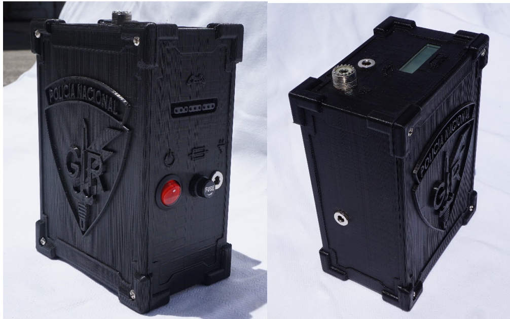
Figura 97. Caja de control para mando a distancia implementada
