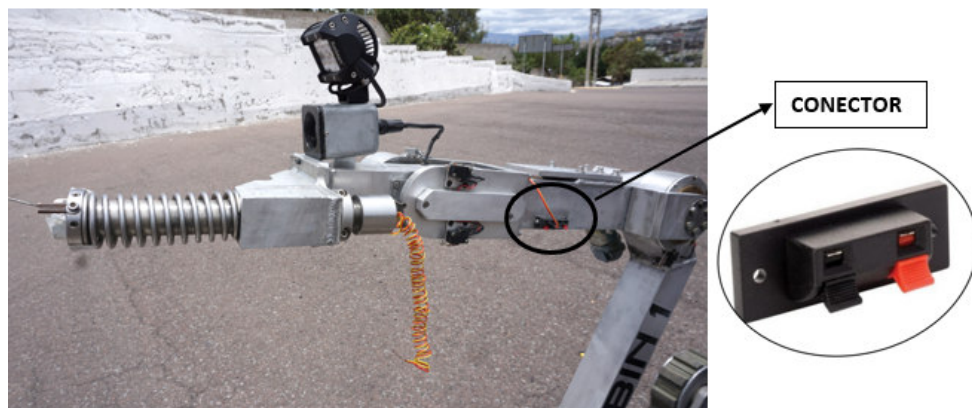
Figura 75. Conector eléctrico para disruptor.
