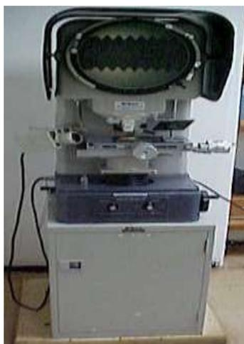
Figura 4 Proyector de perfiles de eje vertical.
