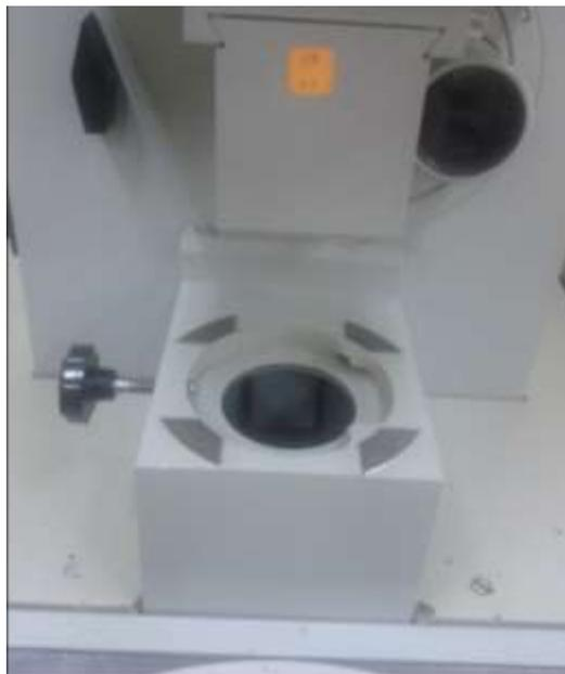
Figura 40 Base original del proyector de perfiles, agujero cónico.
