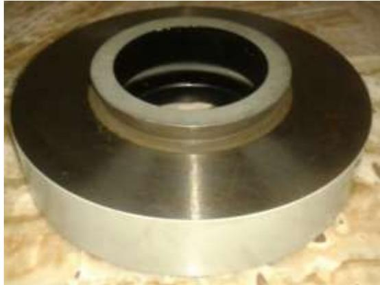
Figura 39 Base original del proyector de perfiles, eje cónico
