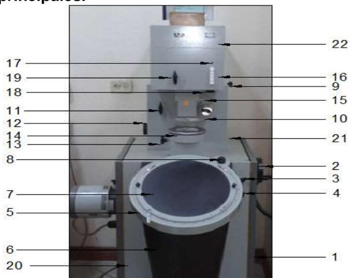
Figura 6 Partes Proyector de Perfiles Carl Seis MP320.
