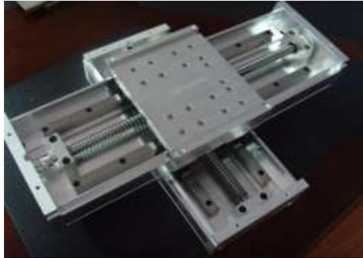
Figura 20 Mesa de desplazamiento XY para máquinas CNC.
