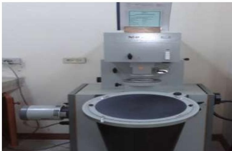
Figura 2 Proyector de Perfiles CARL ZEISS JENA Modelo MP320
