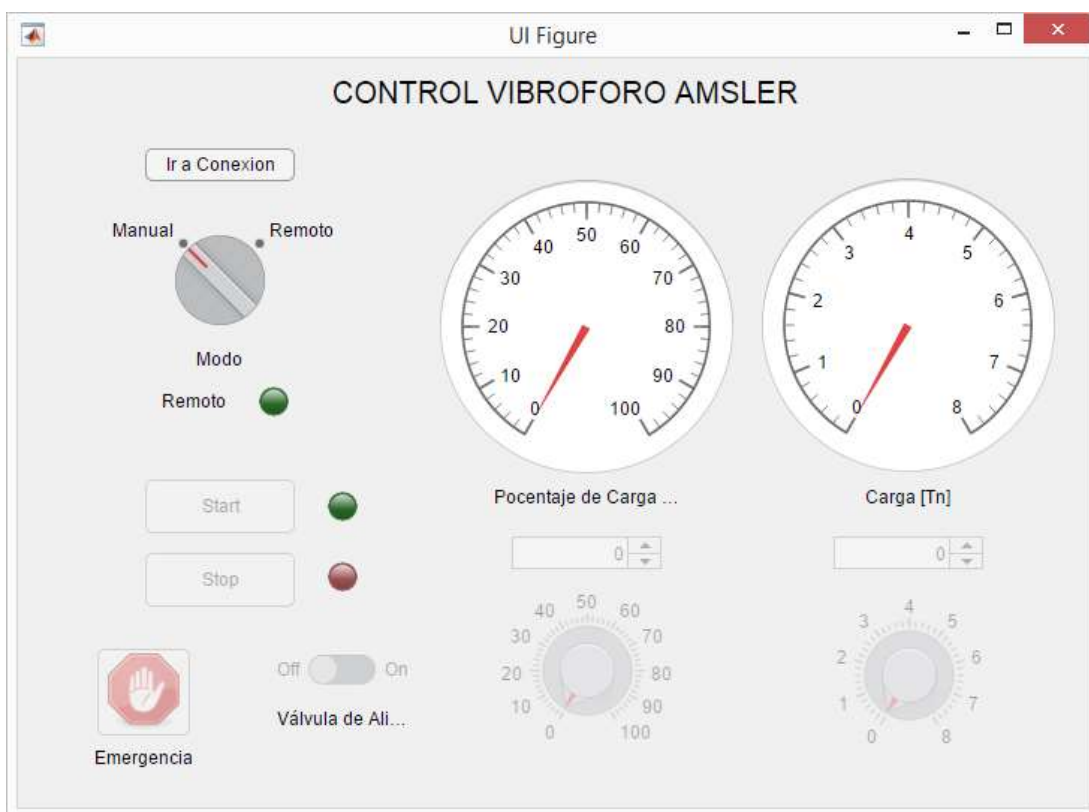
Figura 81 Venta de mando por control manual
