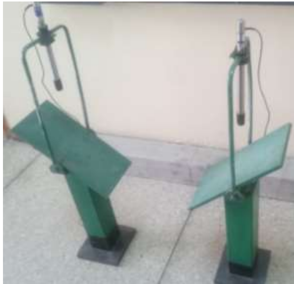
Figura 27 Acoplamiento de los sensores LVDT a los soportes de vigas
