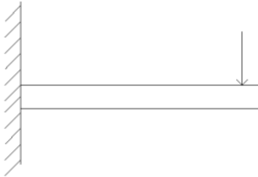
Figura 2 Viga en voladizo
