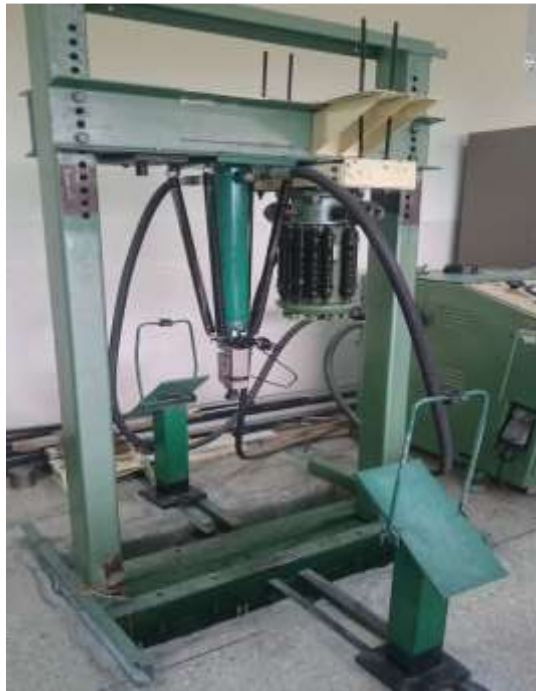
Figura 25 Pórtico de carga del Vibróforo de baja frecuencia
