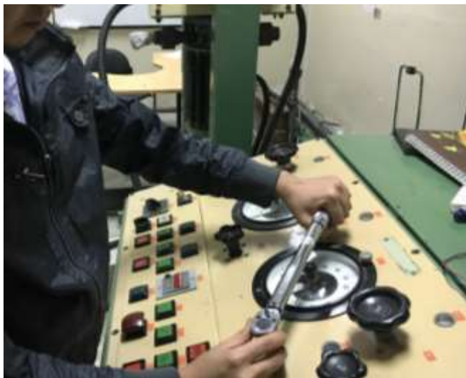
Figura 31 Medición de torque en eje transmitido
