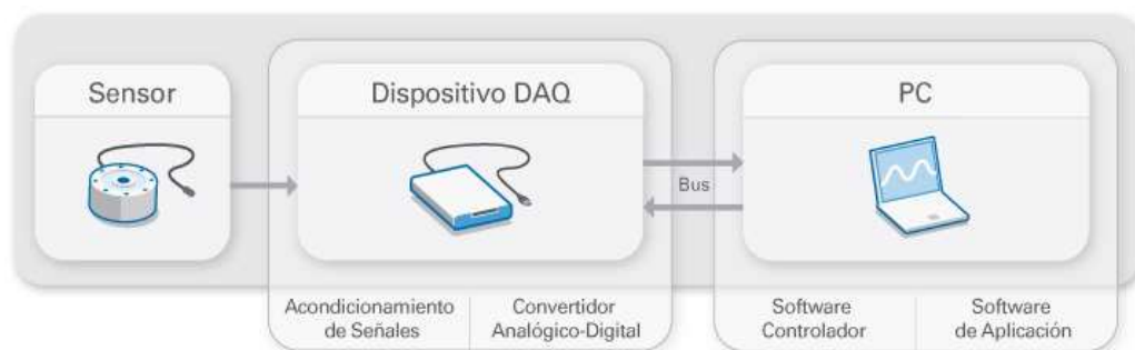
Figura 20 Partes de un sistema DAQ
