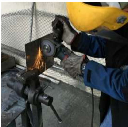
Figura 38 Corte de plancha de acero
