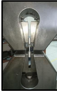
Figura 62. Probeta en máquina de ensayos universales para ensayo de tracción
