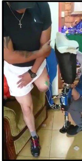
Figura 105. Medición señales mioeléctricas en el músculo recto anterior.
