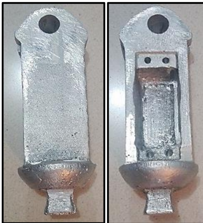
Figura 82. Tobillo en aluminio fundido
