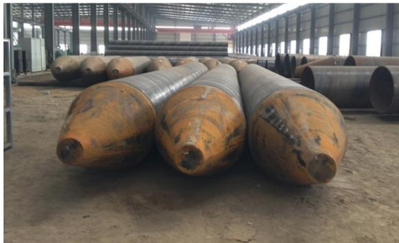
**Figura 3 Pilotes de acero formados por tubos**
