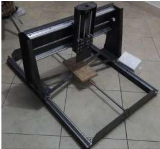
**Figura 68.- Ensamble completo de los ejes XYZ.**
