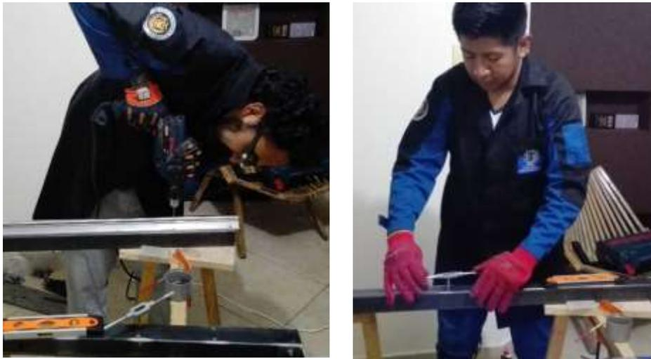
**Figura 60.- Taladrado y machuelado en estructura metálica.**
