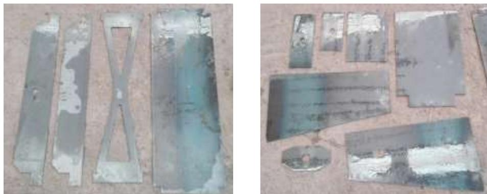
**Figura 59.- Corte de placas de acero por chorro de agua.**
