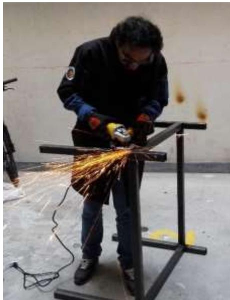
**Figura 61.- Ajustaje y acabado en la estructura de soporte de la máquina.**
