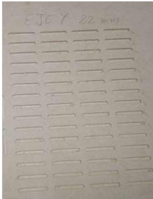
**Figura 80.- Probeta de ranuras en dirección del eje Y.**
