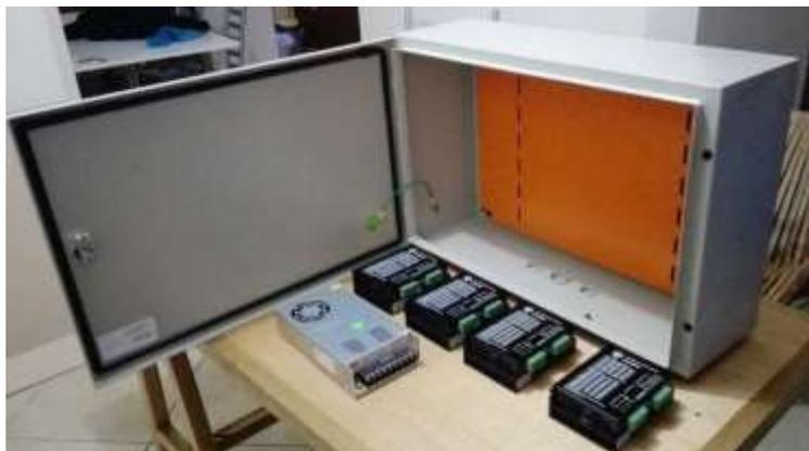
Figura 72.- Gabinete y elementos de control.
