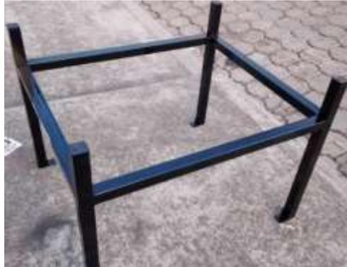
**Figura 66.- Soporte base de la máquina CNC.**
