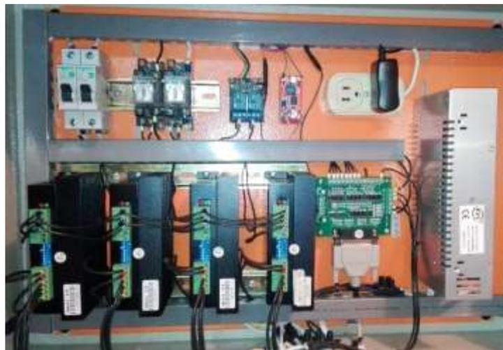
**Figura 74.- Cableado finalizado.**
