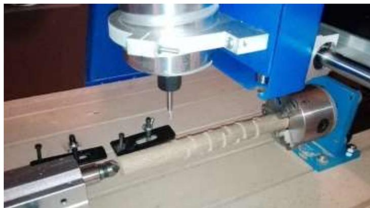
**Figura 86.- Probeta de perforaciones en superficie circular para eje A.**
