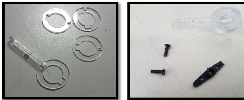
Figura 69: Ensamble llantas traseras, servomotor de brazo porta marcador para trazado de trayectoria
