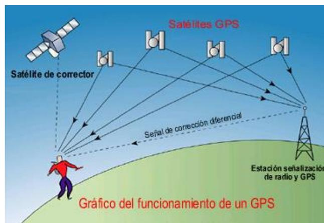
**Figura 1.** Recepción de las señales satelitales del GPS.
