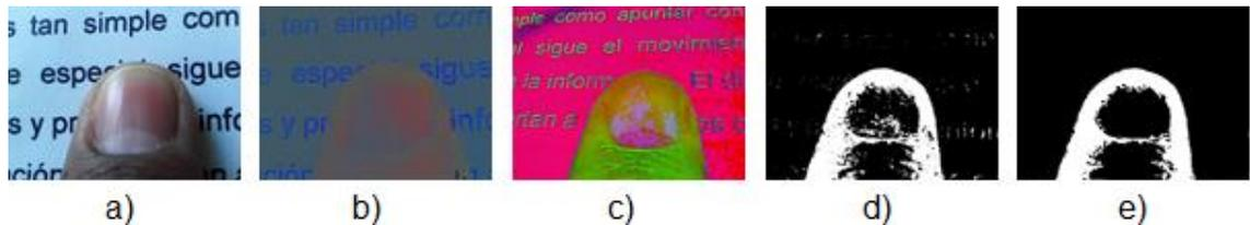
**Figura 33 Máscaras a) Imagen adquirida b) Imagen normalizada c) Imagen en espacio de color HSV d) Máscara con umbral de tono de piel e) Máscara sin ruido**
