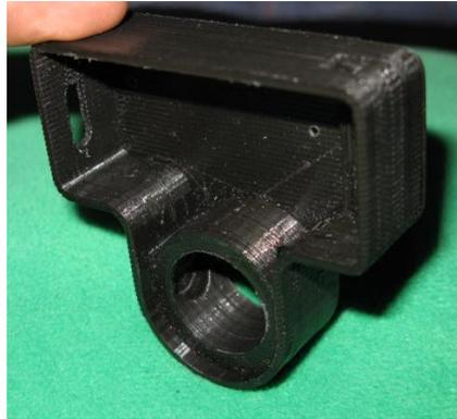
**Figura 46 Acople del anillo y el case posterior**
