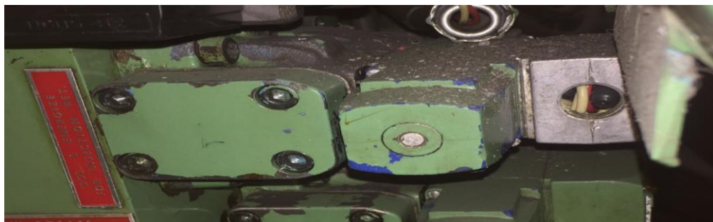
Figura 13 Válvula involucrada en mecanismo de inyección (solenoide L).
