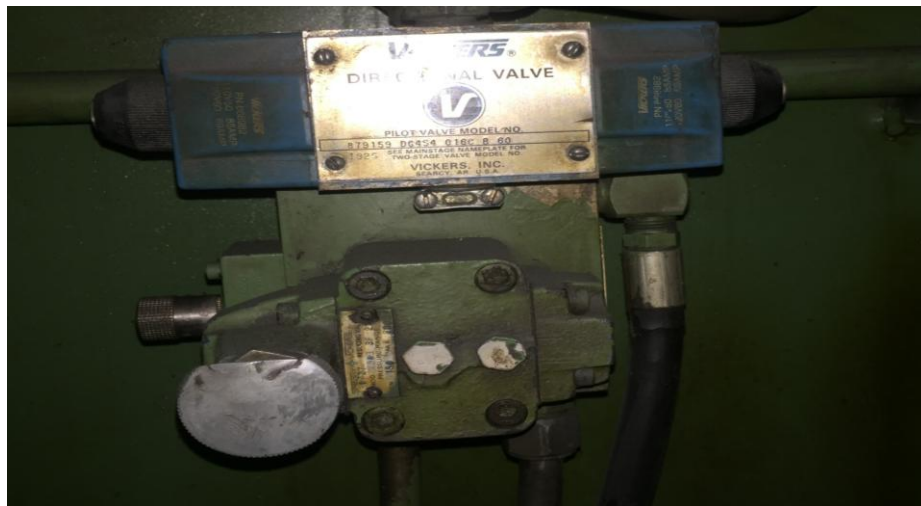
Figura 18 Válvula involucrada en mecanismo de entrada / salida de expulsor (solenoides R y RT).
