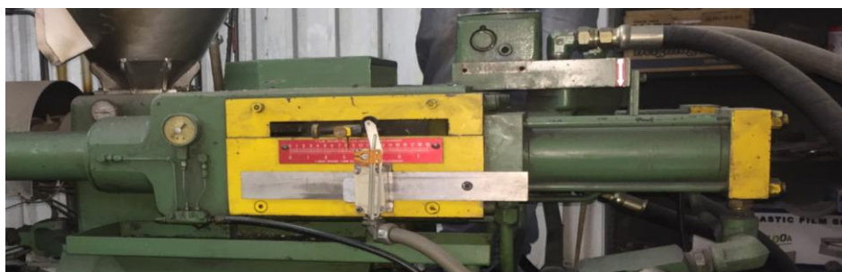
Figura 15 Actuador involucrado en mecanismo de inyección (tornillo/pistón hidráulico).
