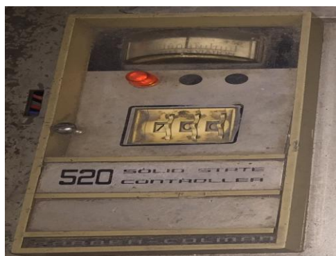
Figura 26 Controlador de temperatura máquina Van Dorn.
