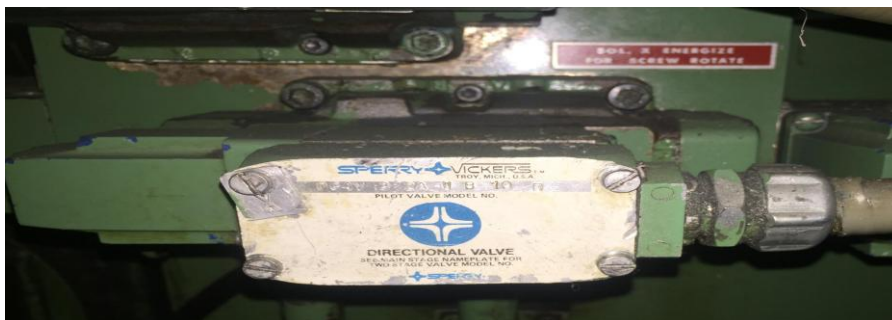
Figura 10 Válvula involucrada en giro de tornillo (solenoide X).
