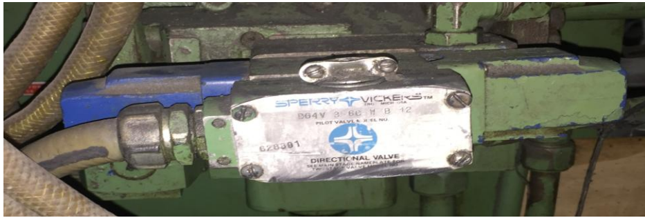
Figura 16 Válvula involucrada en mecanismo de apertura/cierre de molde (solenoide C y N).
