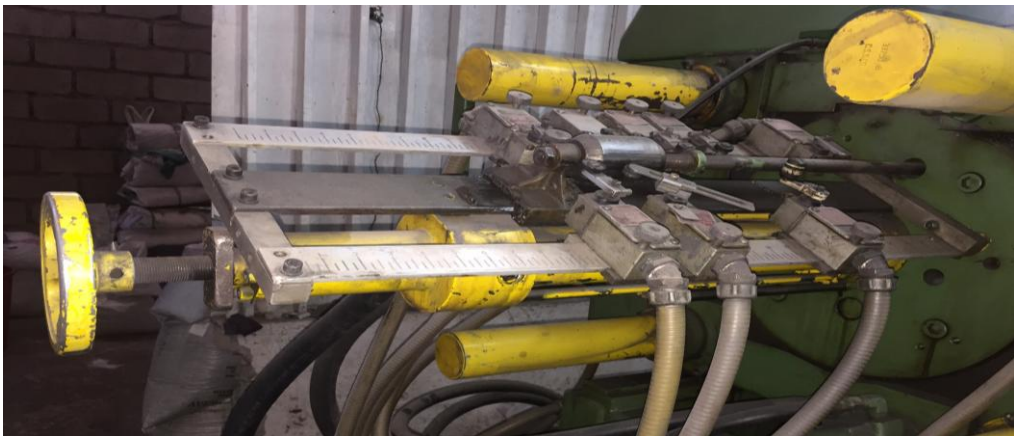
Figura 17 Actuador involucrado en mecanismo de apertura/cierre de molde (pistón hidráulico).
