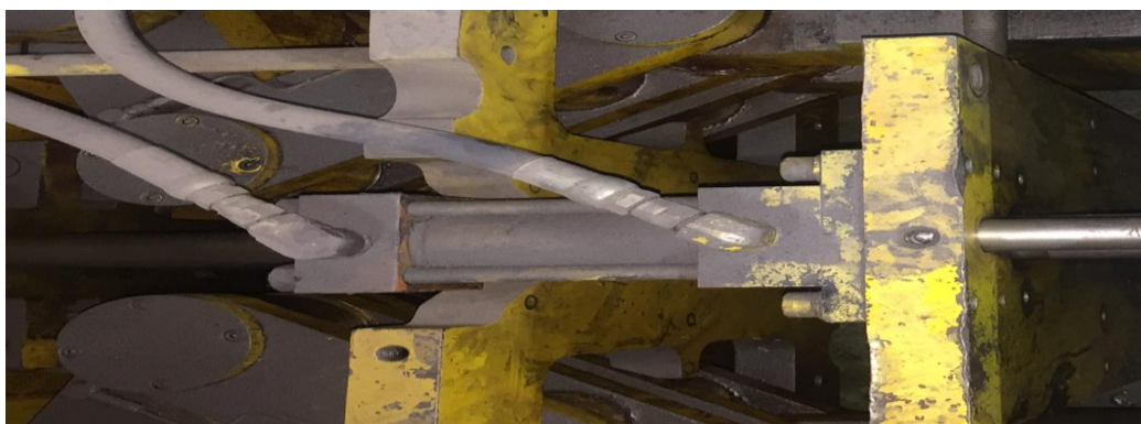
Figura 19 Actuador involucrado en mecanismo de expulsor de piezas (pistón hidráulico).
