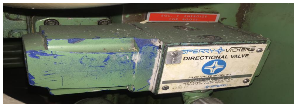
Figura 14 Válvula involucrada en mecanismo de inyección (solenoide F)
