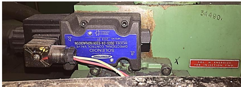
Figura 12 Válvula involucrada en mecanismo de inyección (solenoide H)
