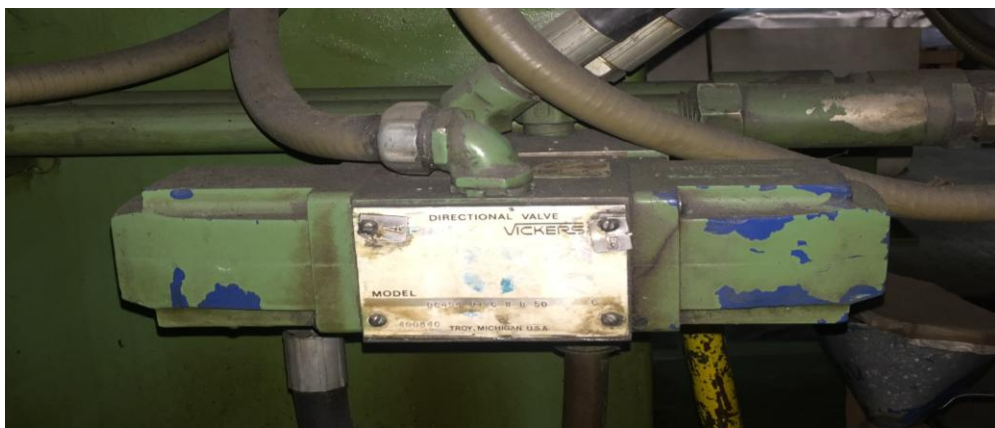
Figura 20 Válvula involucrada en mecanismo de ajuste de molde (solenoides A y B).
