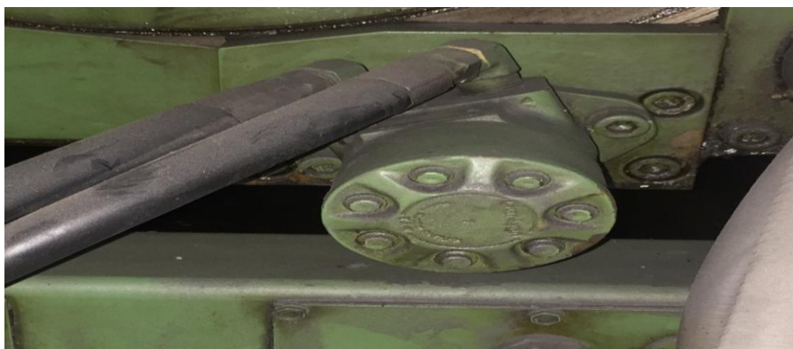
Figura 21 Actuador involucrado en mecanismo de ajuste de molde (motor hidráulico).
