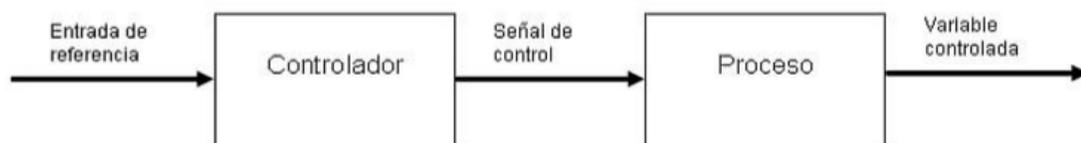
**Figura 17 Diagrama en lazo abierto**
