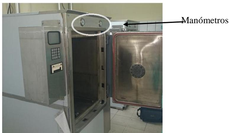
**Figura 35 Manómetros de la autoclave**
