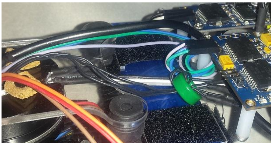
Figura 92: Núcleo de ferrita para en la IMU
