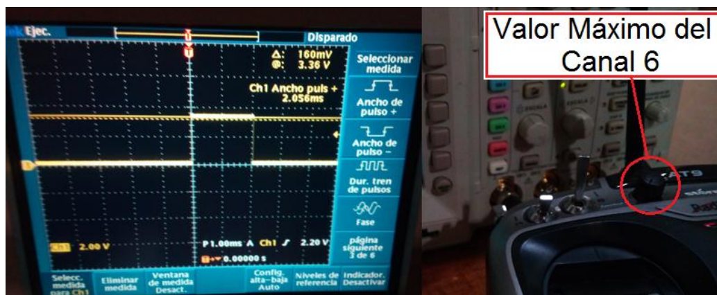
Figura 82: Ancho de pulso del valor máximo de la señal de control
