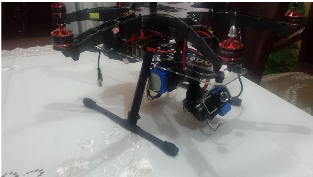
Figura 124: Unión del sistema de estabilización de video al dron
