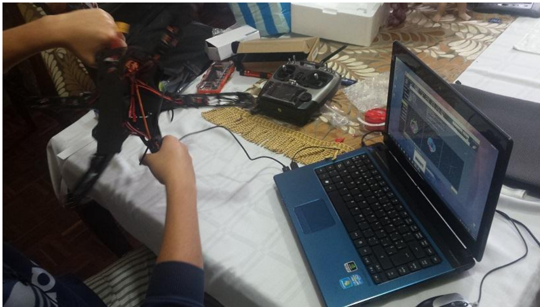
Figura 127: Calibración de los sensores del Pixhawk a través de Mission Planner
