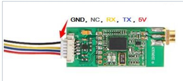
**Figura 75. Conexiones del módulo esclavo a la tarjeta de control y fuente**
