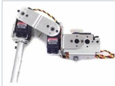
**Figura 13. Diseño de la pata del robot hexápodo**
