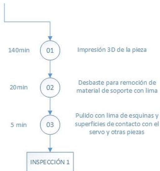
**Figura 102. Diagrama de proceso de bracket servo coxa 2**
