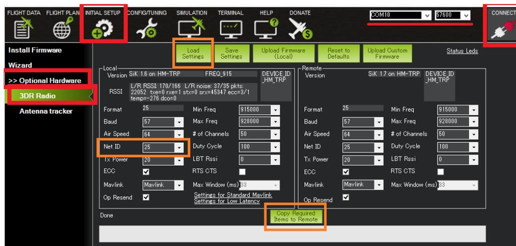
Figura 74. Interfaz para configurar el 3DR *Radio Telemetry*
