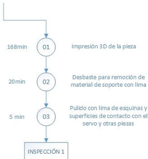
Figura 101. Diagrama de proceso de bracket servo coxa 1
