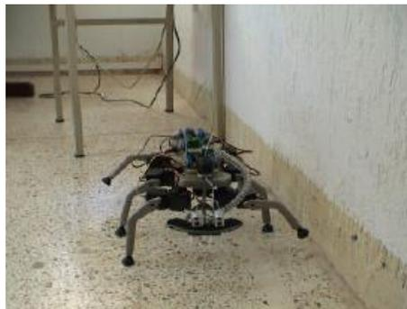
**Figura 9. Caminata sobre superficie lisa - Robot hexápodo**
