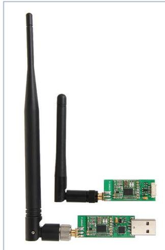
**Figura 73. Módulos de radiofrecuencia 3DR *Radio Telemetry* (Maestro y Esclavo)**
