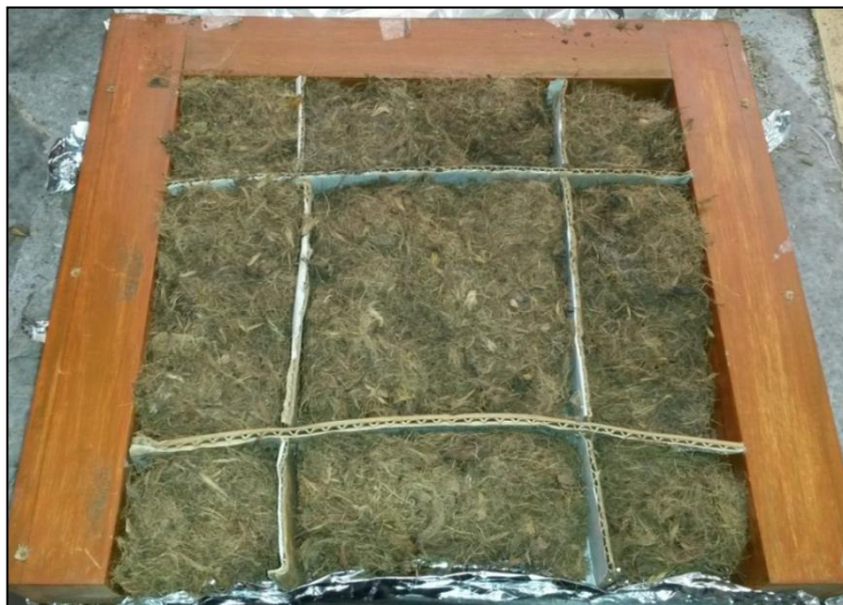
Figura 21. Colocación de la fibra de palma en la distribución de cartón en el molde.
