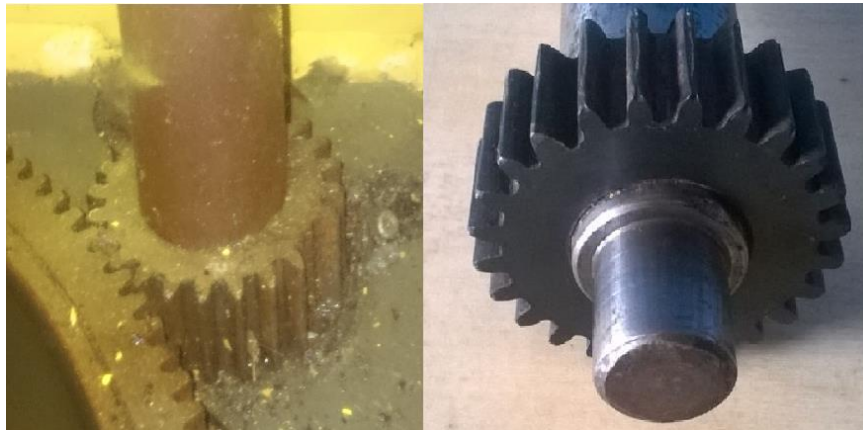
Figura 75 Engrane dañado y engrane fabricado
