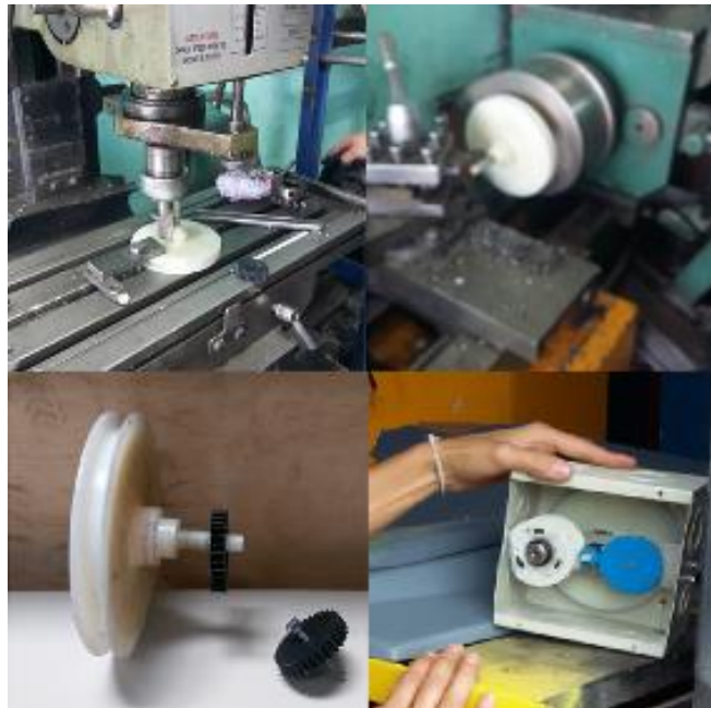
Figura 76 Construcción de mecanismo para medición de altura
