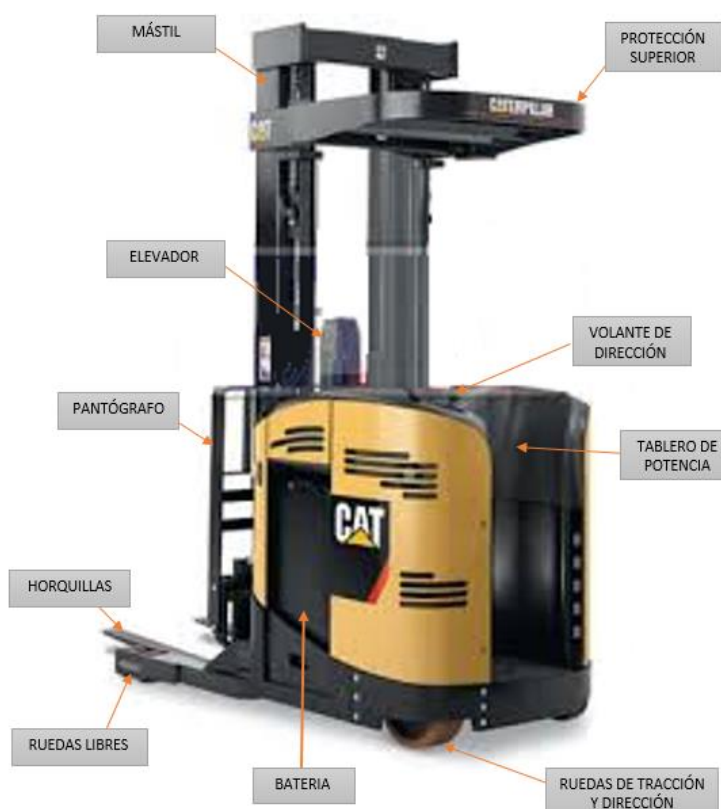
Figura 2 Partes del Montacargas marca Caterpillar modelo NRDR30
