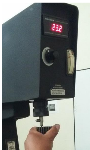
Figura 20 Dureza alcanzada en Rockwell C de piñón roto
