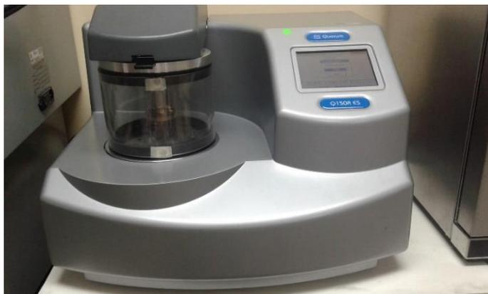
**Figura 11. Recubrimiento con 20 nm de oro por 2 minutos.**
