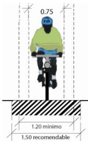
**Figura 24.** Ancho de Ciclovía Unidireccional
