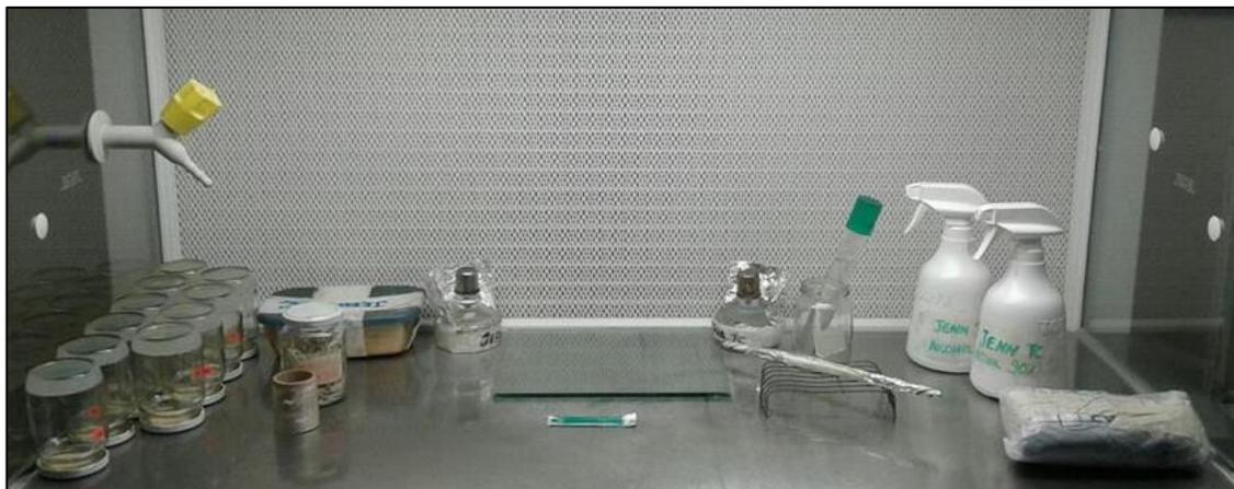
**Figura 12. Cámara de flujo utilizada para realizar la introducción de los explantes.**
