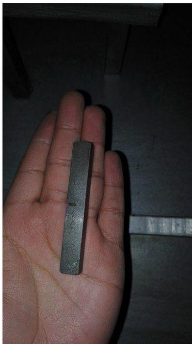
**Figura 174. Probetas para el ensayo Charpy**
