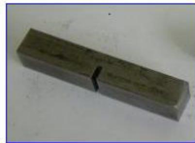
**Figura 16. Forma y posición de la probeta en el ensayo Charpy**
