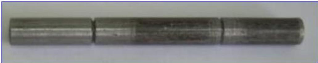
**Figura 18. Forma de la probeta para la prueba Izod**
