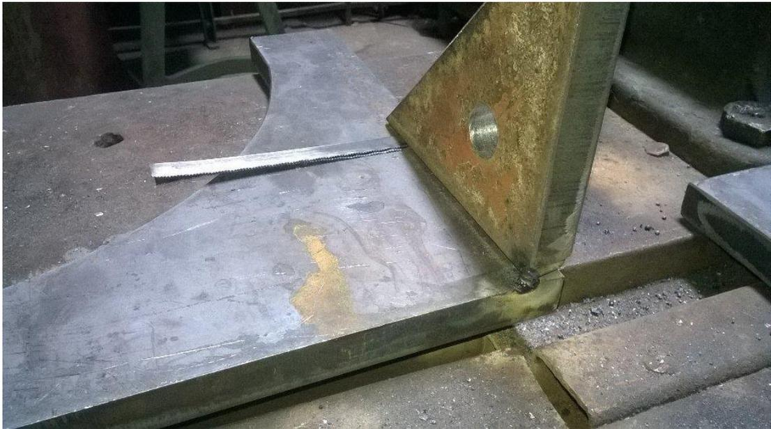
**Figura 164. Soldadura de la bases del canal U**
