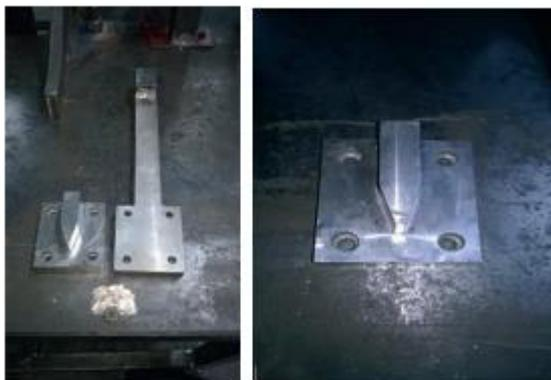
**Figura 170. Manufactura CNC y oxicorte percutores**
