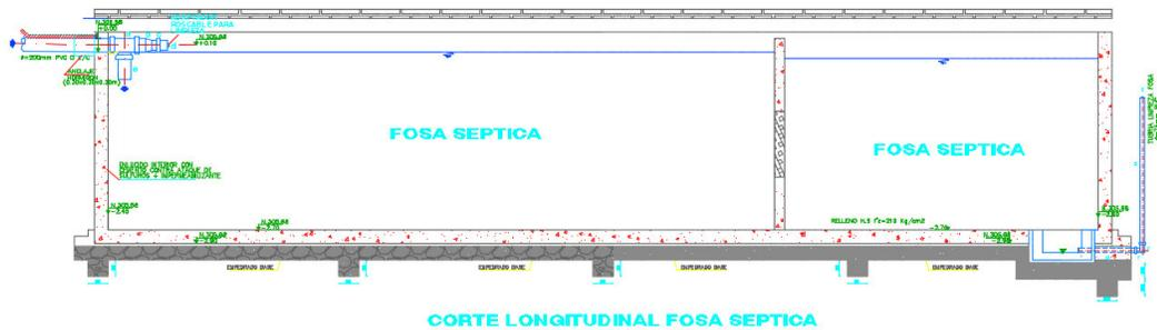
**Figura 35: Corte del Tanque séptico típico**
