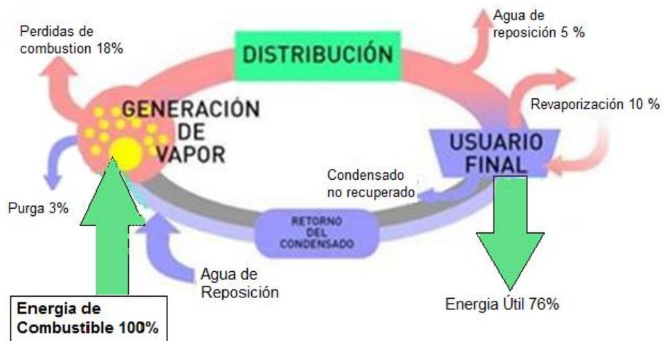
Figura 16. Proceso de generación y distribución de vapor.
