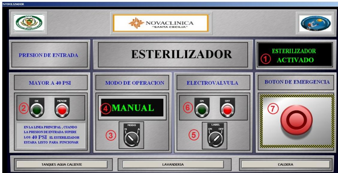
Figura 148. Elementos gráficos – Esterilizador.
