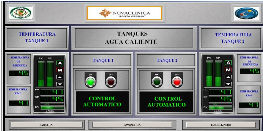
Figura 160. Control Temperatura Tanques - HMI
