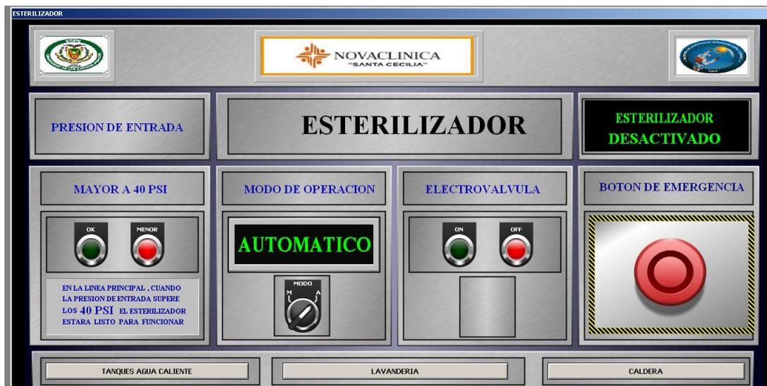
Figura 147. Elementos gráficos - Esterilizador.
