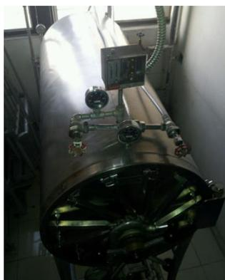
Figura 163. Control Presión -Presuretrol - Esterilizador
