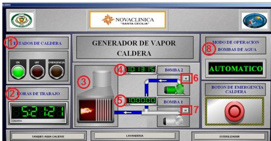
Figura 141. Elementos gráficos-Generador de vapor.
