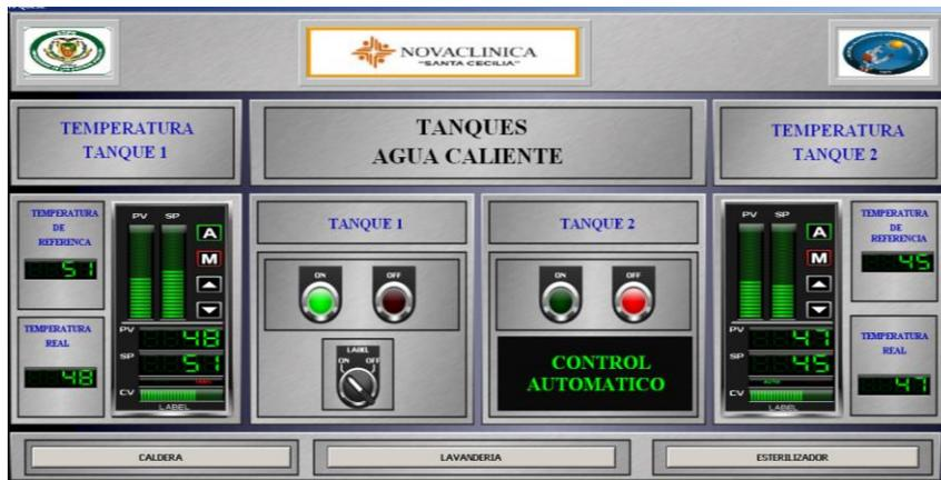
Figura 161. Control temperatura tanque N1 - Modo manual.
