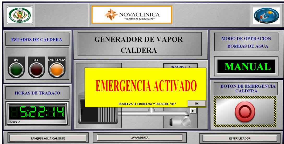
Figura 156. Emergencia activado – HMI.
