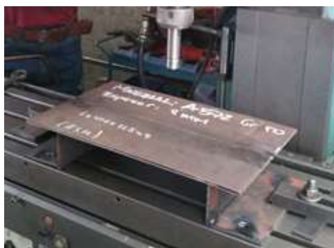
Figura 3 Sistema de sujeción o anclaje para el proceso de soldadura FSW, imagen en las instalaciones de la empresa auspiciante
