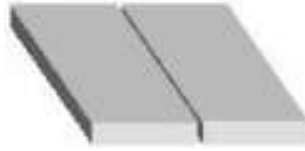
Figura 9. Junta a tope
