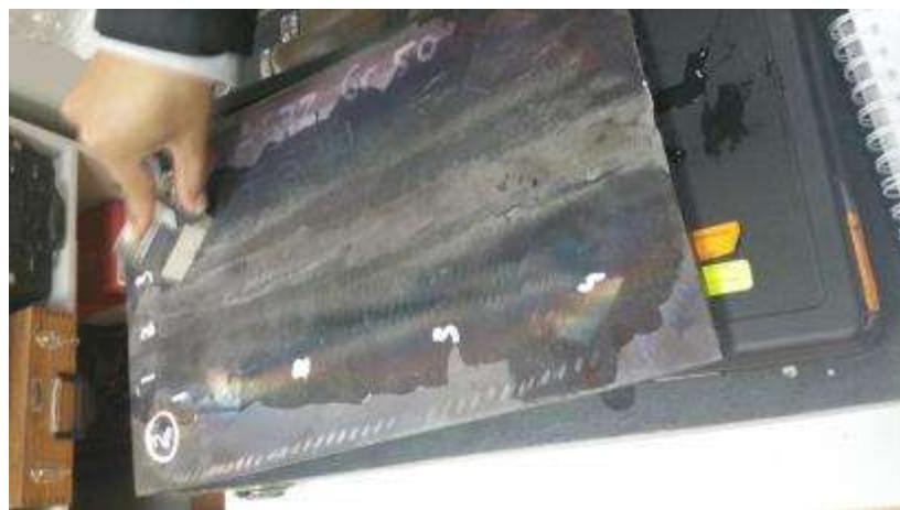
Figura 60 Inspección volumétrica de placa de 6 mm
