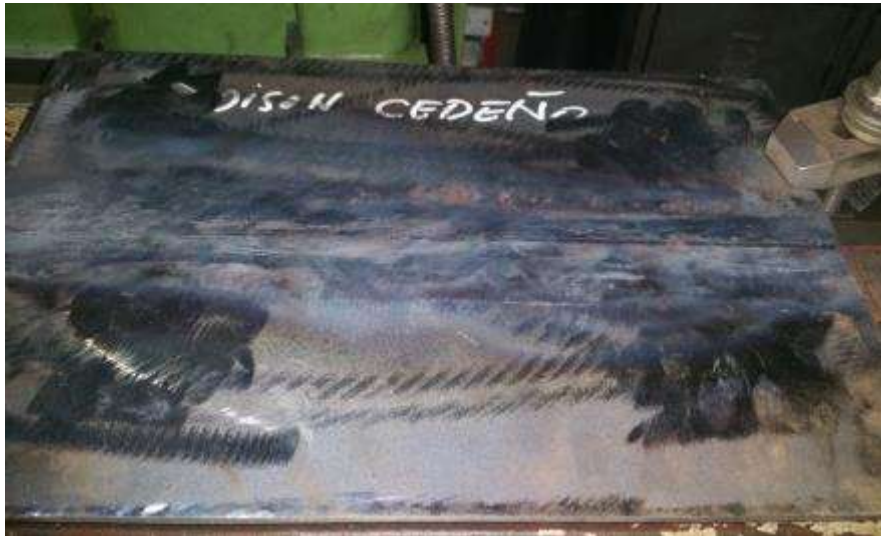
Figura 56 Inspección Visual de la placa de 6mm
