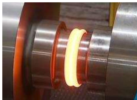
Figura 19 Soldadura por fricción para unión permanente
