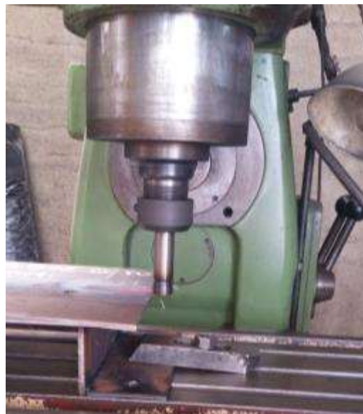
Figura 39 Velocidad de rotación de 3000 RPM para la máquina – herramienta utilizada.
