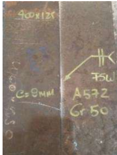
Figura 12 Armado de la Plancha con una junta a tope sin preparación de bisel para una prueba en un espesor de 8 mm
