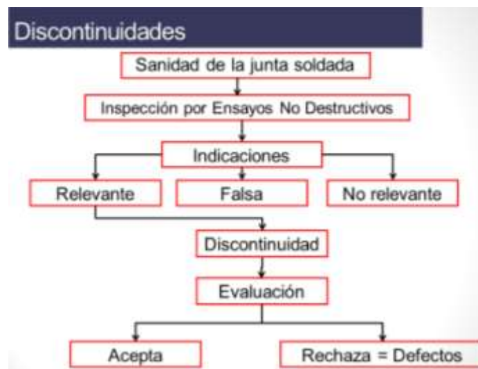
Figura 43 Secuencia de identificación de defectos
