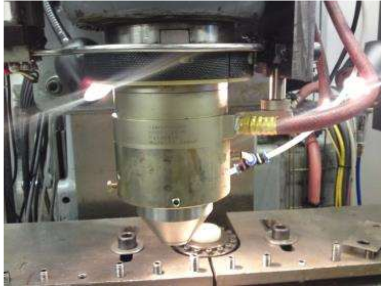
Figura 24 Husillo con sistema de enfriamiento
