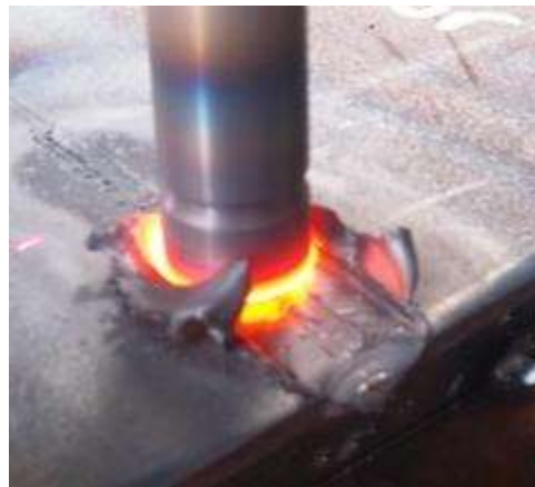
Figura 46 Exceso de destello para la placa de 6 mm
