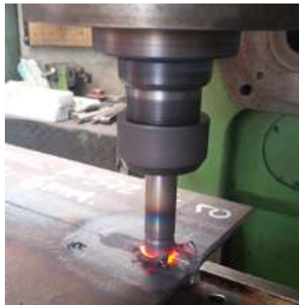
Figura 41 Soldadura de fricción rotativa en progreso de dos planchas
