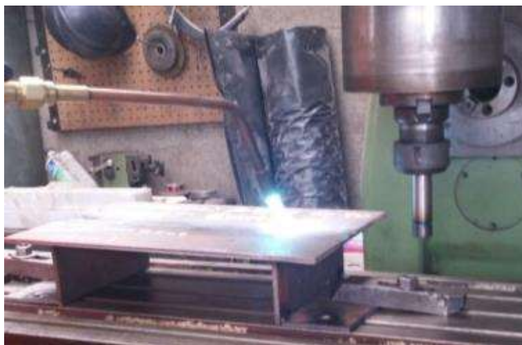
Figura 2 Representación de un proceso de soldadura FSW, instalaciones de la empresa auspiciante del proyecto
