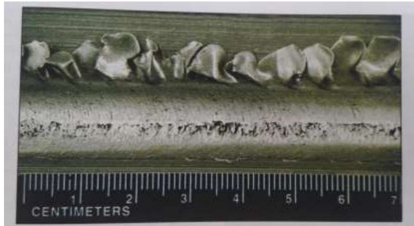
Figura 45 Exceso de destello en soldadura FSW para una aleación de aluminio 6061-T6
