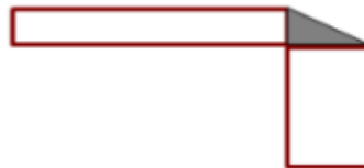
Figura 13 Junta de esquina
