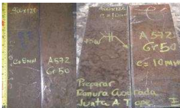
Figura 37 Preparación de planchas para espesores de 8 y 10 mm.
