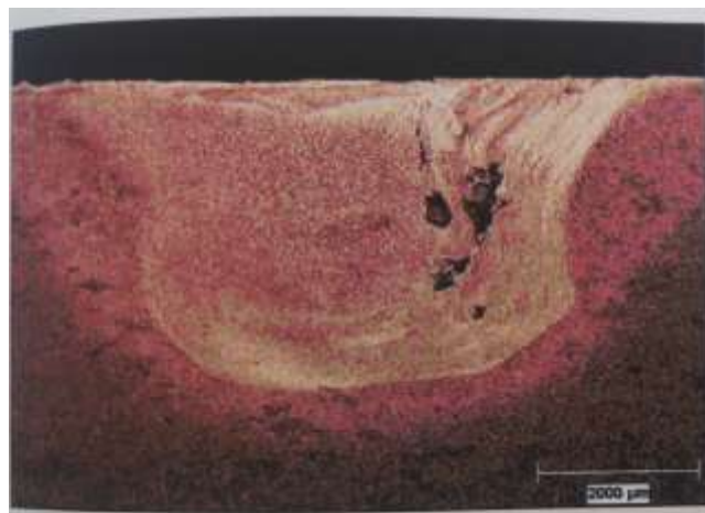
Figura 48 Cavidad interna (agujero de gusano) en una soldadura FSW de un material aluminio 6061-T6
