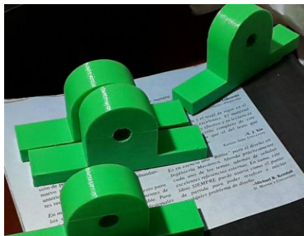
Figura 42 Aisladores fijos de barras anódicas.
