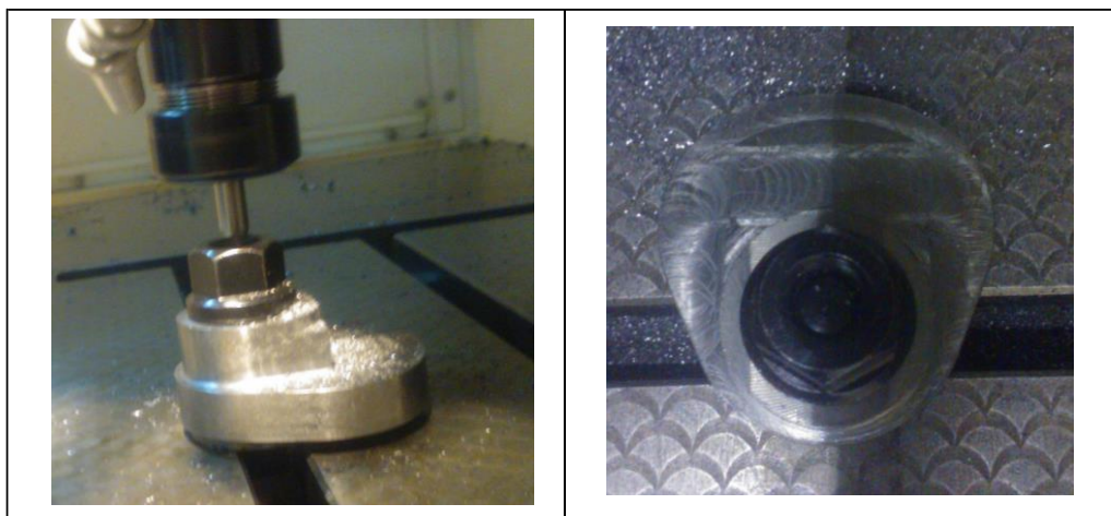
Figura 84. Tercer desbaste – Fresadora CNC
