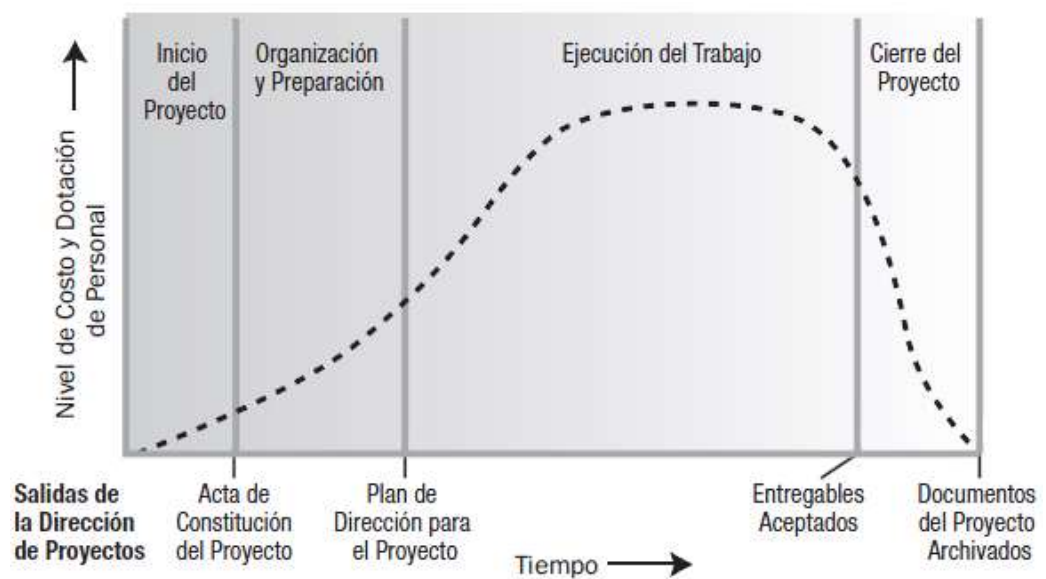
Figura 10 Niveles típicos de costo y dotación de personal a través de la estructura genérica del ciclo de vida del proyecto
