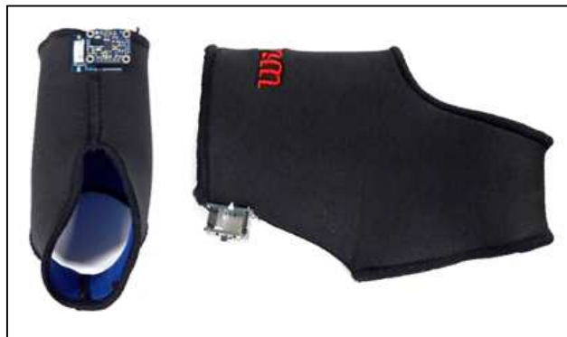
Figura 71 Colocación del IMU en la tobillera
