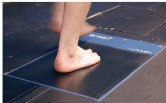
Figura 82 Plataforma para medir la presión de la pisada
