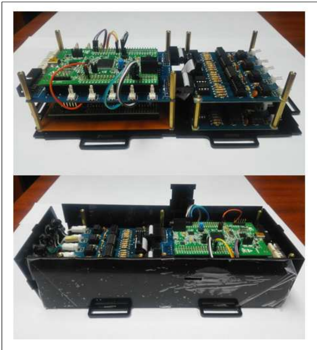
Figura 120 Ubicación de placas dentro de carcasa
