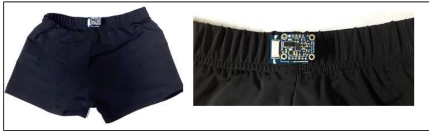
Figura 73 Colocación del IMU en la licra
