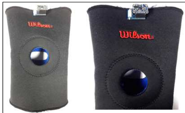
Figura 72 Colocación del IMU en la rodillera
