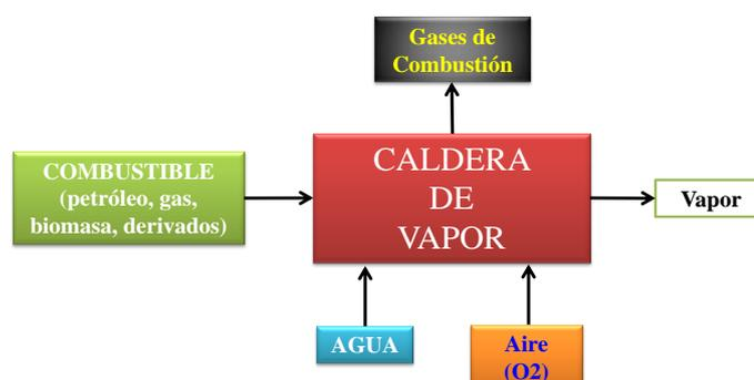
Figura 2 Diagrama conceptual del funcionamiento de una caldera de vapor
