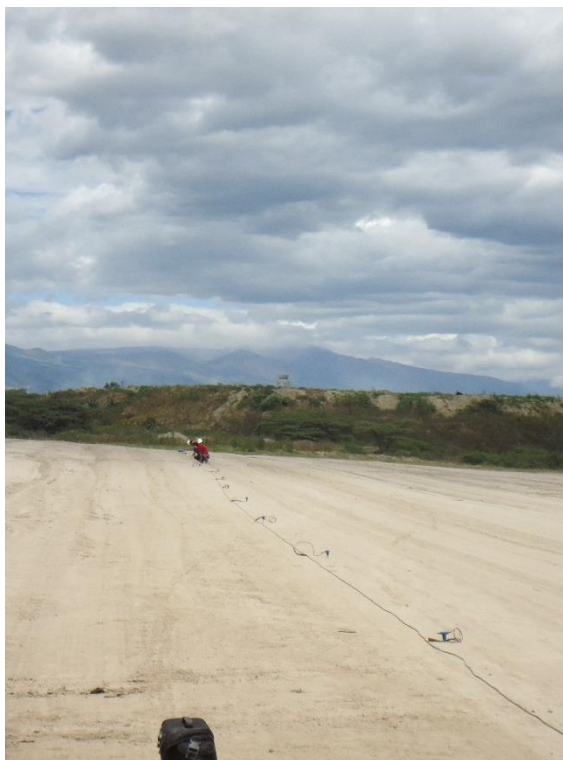
Figura 21 Sísmica de refracción tendido de la línea sísmica
