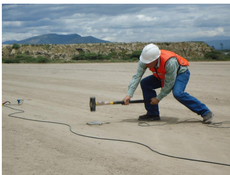
Figura 23 Sísmica de refracción golpe de martillo
