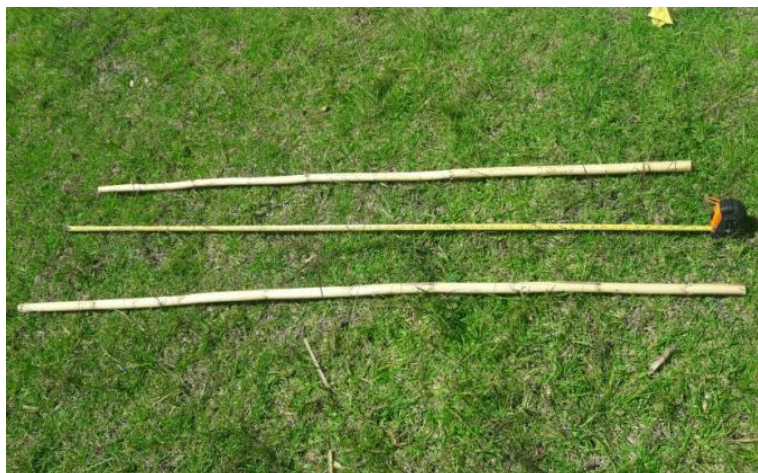
Figura 82: Elemento vertical y diagonal de 2m y 2.10 m respectivamente (Modulo 1)
