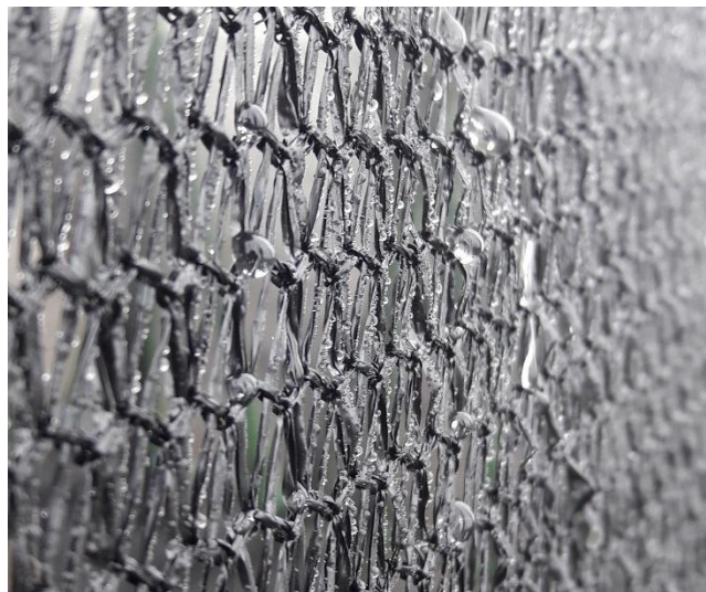
Figura 21: Malla de Poliéster con presencia de gotas de agua que chorrea por efecto de la gravedad
