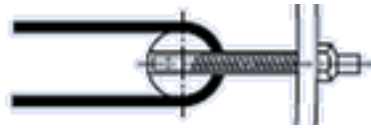
Figura 18 Sistema de ajuste por tornillo Fuente: (Forbo Movement Systems, 2014)
