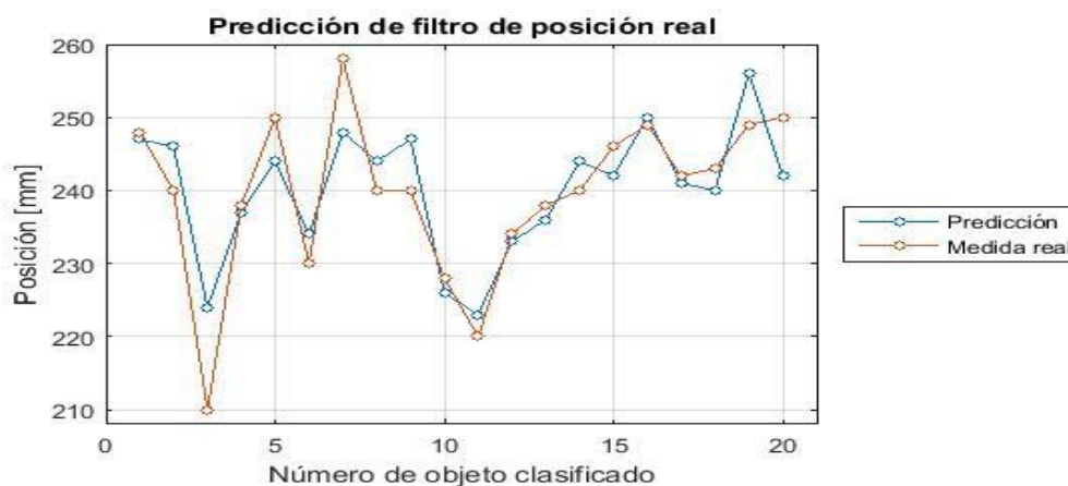
Figura 82 Comparación entre Predicción de Filtro y Posición real clasificación por color
