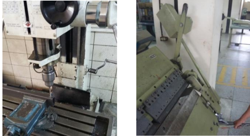
Figura 61 Taladrado y doblado de piezas
