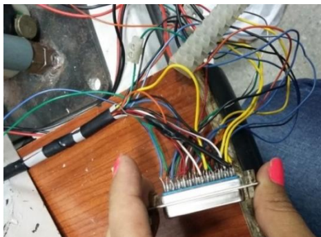
Figura 51 Bornera soldada los cables de los elementos del robot
