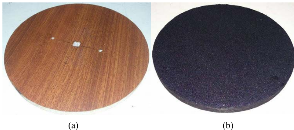
Fig. 81. Plato giratorio: (a) Elemento cortado (b) Elemento terminado.
