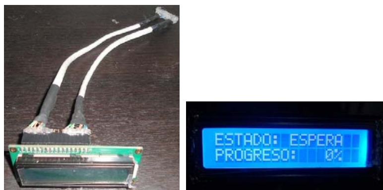
Fig. 94. LCD 16x2: (Izq.) Conexión y (Der.) Funcionamiento.
