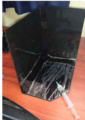
Fig. 85. Proceso de pegado de acrílico.
