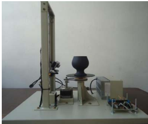
Fig. 5. Sistema para digitalización de objetos en 3D. Fuente: (Andrés Sosa, 2013)
