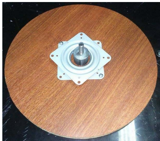
Fig. 90. Ensamble subconjunto plato giratorio.
