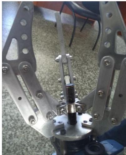
**Figura 101. Gripper de tres pinzas**
