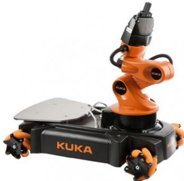
**Figura 25. Manipulador Móvil Omnidireccional Brazo KUKA youBot**
