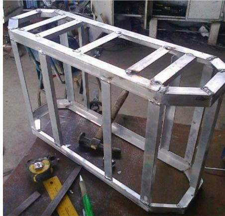
**Figura 87. Conformación de la estructura**
