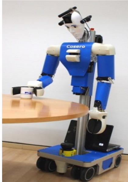
**Figura 22 Manipulador Móvil Humanoide Cognitive Service Robot**
