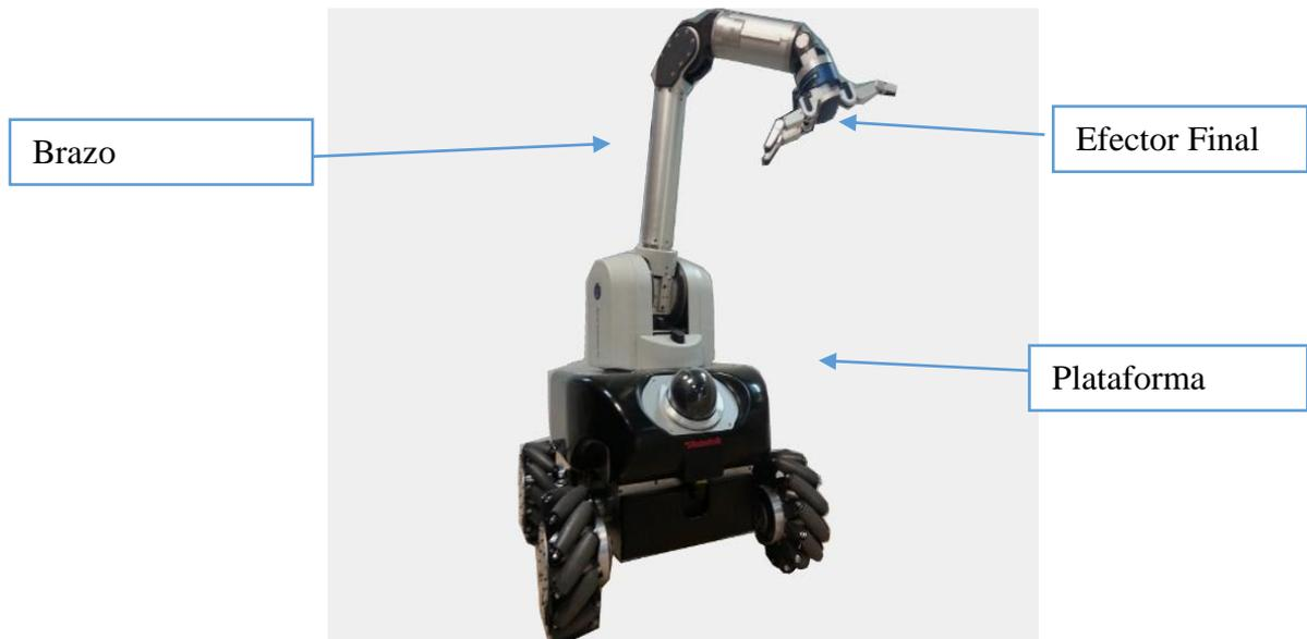
**Figura 21 Manipulador Omnidireccional. XWam-Robotnik**
