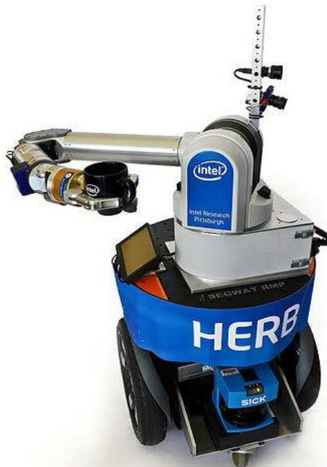
**Figura 24. Manipulador Móvil Bidireccional Home Exploring (HERB)**
