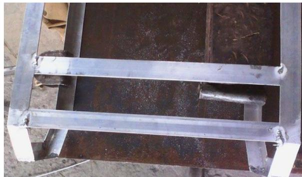
**Figura 86. Soldadura perfiles transversales**
