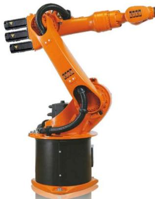
**Figura 16 Brazo robótico articulado KUKA KrR 6-2 Robotis**
